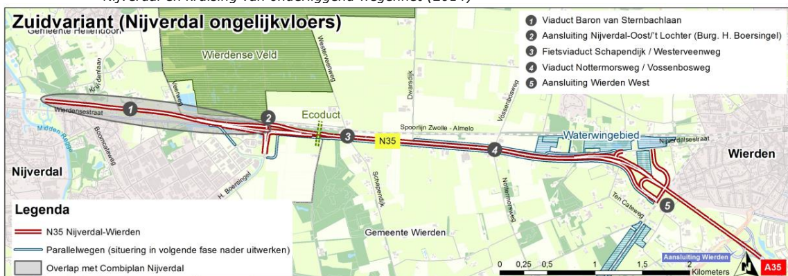
Figuur 3.16 Schematische weergave van de zuidvariant met ongelijkvloerse aansluiting en kruising in Nijverdal en kruising van onderliggend wegennet (2014)
