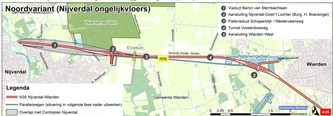
Figuur 3.14 Schematische weergave van de noordvariant met ongelijkvloerse aansluiting en kruising in Nijverdal en kruising van onderliggend wegennet (2014)
