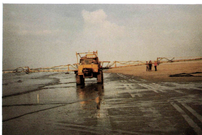
De oppervlakte sproeikapaciteit van de landbouwsproeiwagen is lager dan die van het vliegtuig.
