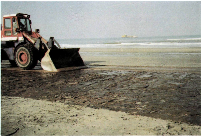
De laadschop schuift de mousse naar het einde van proefvak A.
