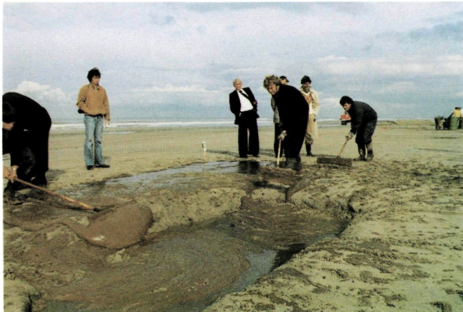
In vergelijking met het op een hoop of richel schuiven neemt bij het in een kuil schuiven van de mousse het zandgehalte met ca. 10% toe.
