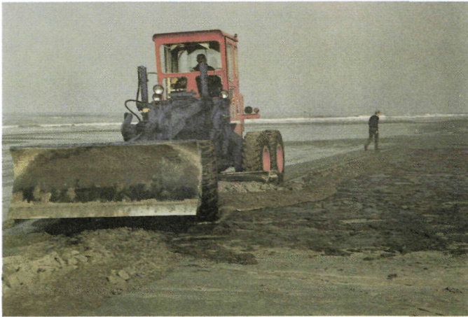
Diverse verzamelwijzen zijn getest, zoals hier het op een richel schuiven van de mousse door een grader.
