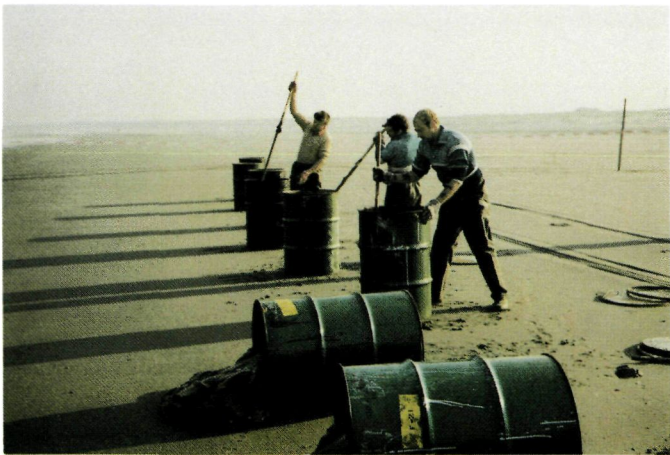
Stilstaand is de viscositeit van de mousse 400.000 cp en in beweging gebracht 18.000 cp (bij 10°C). Hier wordt de olie voordat zij werd uitgespreid geroerd.
