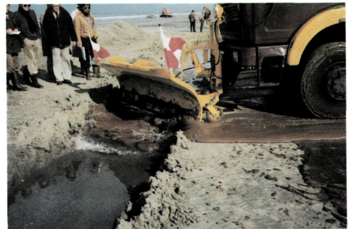
Door wielsporen en de afstelling van het schuifblad blijft erg veel olie in en op het proefvak H achter.
