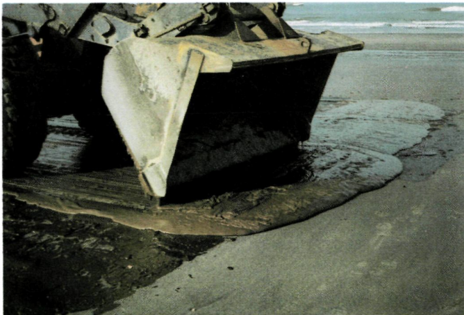
Het op een hoop schuiven van de mousse gaat met een laadschop het best.
