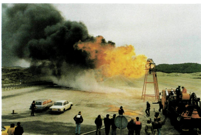
Onbehandelde mousse (69% water en 31% ruwe olie) kan goed worden verbrand indien tweemaal zoveel gasolie aan de ondersteuningsverbranders worden toegevoegd.
