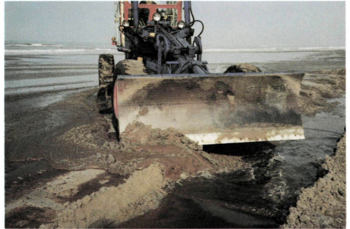
Het nadeel van het gebruik van een sleuf is dat er erg veel zand in de verzamelde mousse komt door inkalving.
