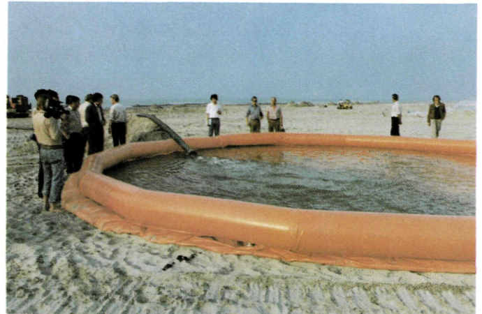
De kraag van het bassin wordt met lucht opgepompt. Bij het vullen van het bassin gaat de drijfkraag mee omhoog.
