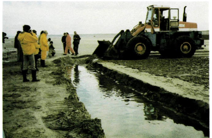
De wiellaadschop kan behalve als schuifmiddel voor diverse andere opruimwerkzaamheden worden ingezet b.v. als laad- en transportmiddel.
