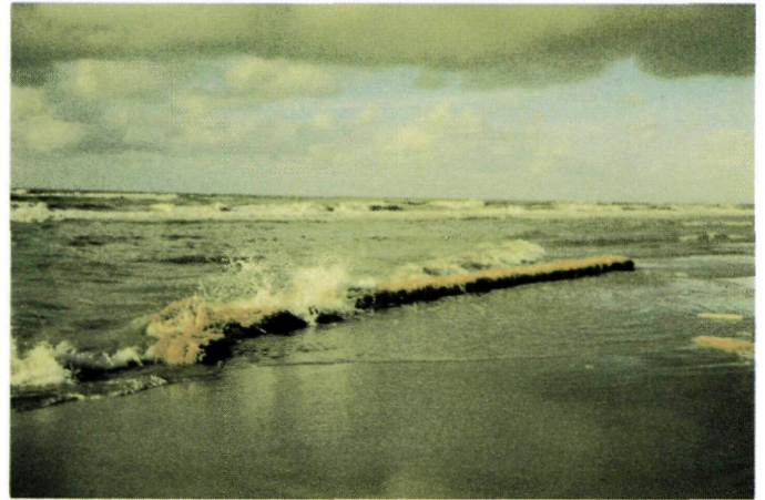
Het oliekerende en olieabsorberende strobaleenscherm slaat bij opkomend water kapot.
