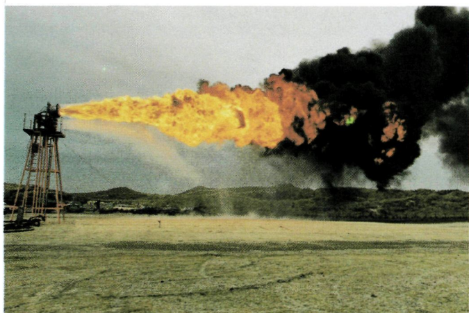
Verbranden van afgetopte (220°C) ruwe olie zonder gaslietoevoeging.
