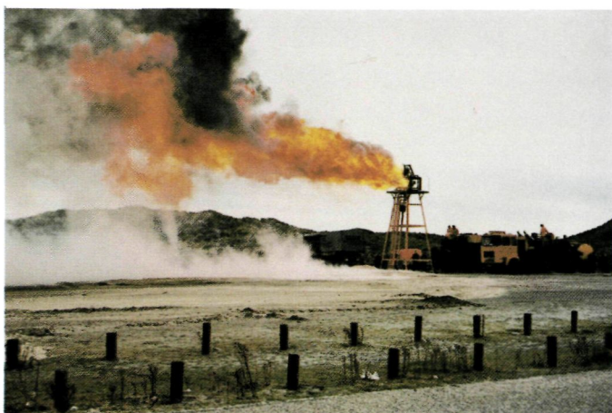
Voor het verbranden van een hoeveelheid met demulsifier behandelde mousse (25% water en 75% olie) is eenzelfde hoeveelheid gasolie als ondersteuningsbrandstof nodig.
