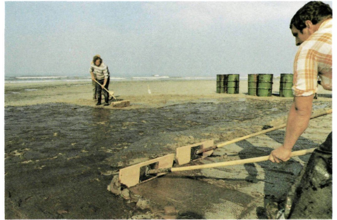
Deze eenvoudig te maken schuifplanken voldoen prima. Schuiven met een plankbreedte tussen 40 en 60 cm zijn het best hanteerbaar.
