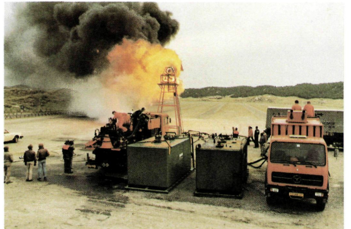
De van het strand afkomstige olie wordt met een "oil mud burner" vernietigd. Hier de opslagtanks voor de mousse en de benodigde gasolie.
