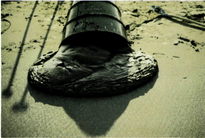
De (thixotropische) kunstmatig nagemaakte "chocolate mousse" bestaande uit 69% zeewater en 31% afgetopte ruwe olie.
