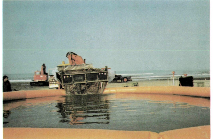
Met de vrachtwagen wordt de olie van proefvak A in het 1m hoge drijfkraagbassin gekiept.
