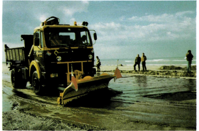
De sneeuwschuif blijkt een goed schuifmiddel te zijn. De vrachtwagen maakt echter wel diepe sporen en de kans op vastlopen in het zand is groot.
