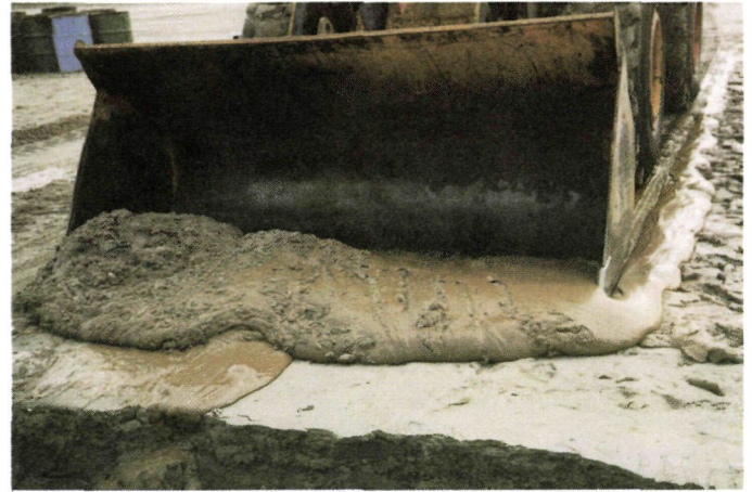
Bij het schuiven wordt de thixotropische mousse aanzienlijk minder visceus ca 14.000 op 10°C.
