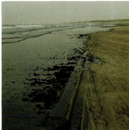
Na de derde proefdag was er op de vloedlijn olie zichtbaar, deze is verwijderd. Een maand na de proeven is het hele proefgebied systematisch op oliesporen tot 50 cm diep onderzocht. Hierbij is visueel geen olie meer waargenomen.
