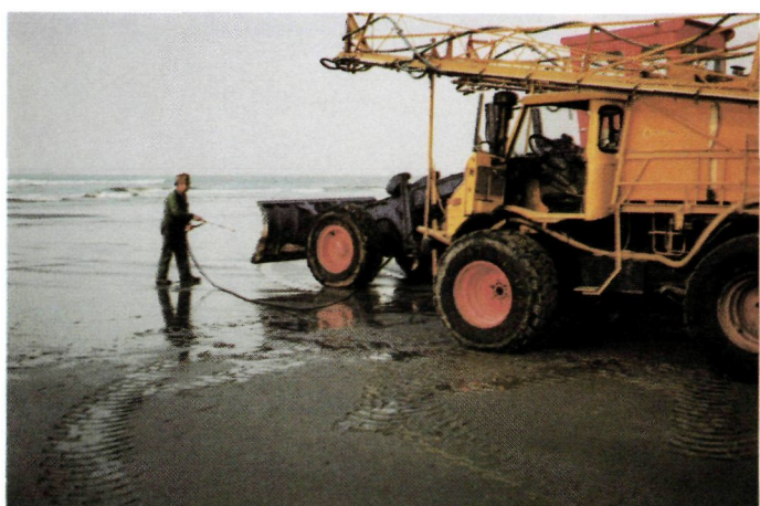
De sproeiwagen wordt ook gebruikt om het ingezette materieel na afloop van de proeven te reinigen.
