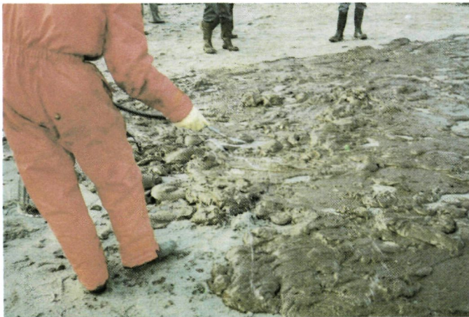
De demulsifier wordt over het proefveld gespoten.
