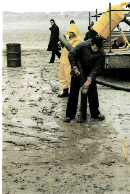
Vacuümsystemen voldoen goed. Speciale zuigmonden kunnen de capaciteit nog aanzienlijk verhogen.
