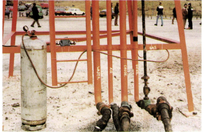
Het verbranden van de mousse is niet eenvoudig. Voor een goede verbranding moeten mousse-, gasolie-, lucht en water in de juiste verhoudingen worden gedoseerd.
