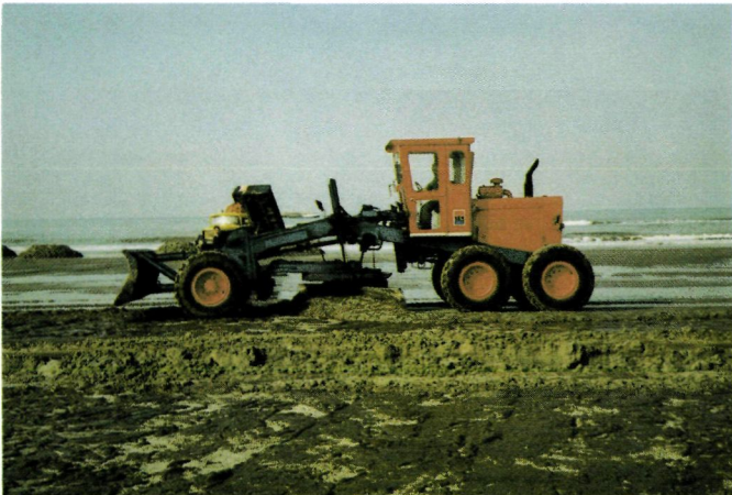
Van alle geteste wegebouwmiddelen voldoet de grader het slechtst, deze neemt het meeste zand mee.
