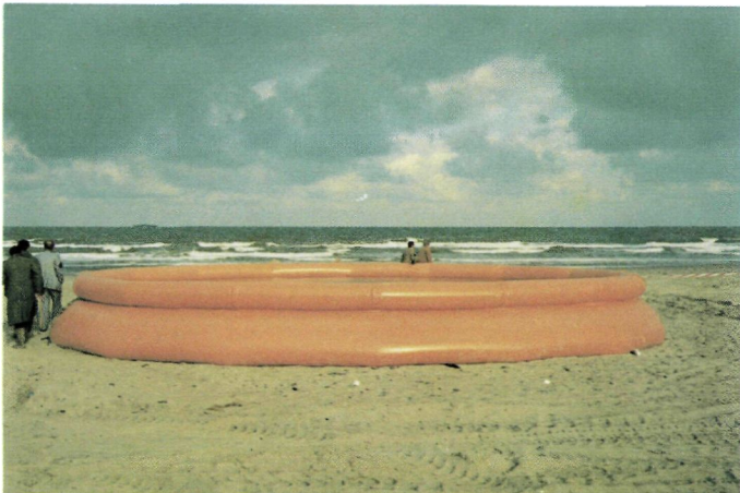
Het geheel gevulde bassin kan 100 m 3 vloeistof bevatten.
