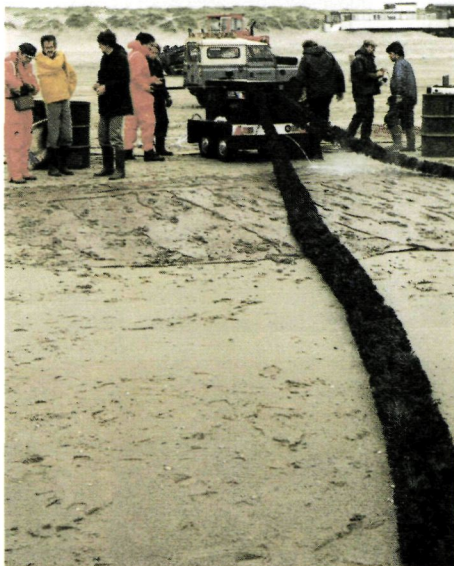
De oil mop (olieabsorberende band) is ongeschikt om mousse te verwijderen.
