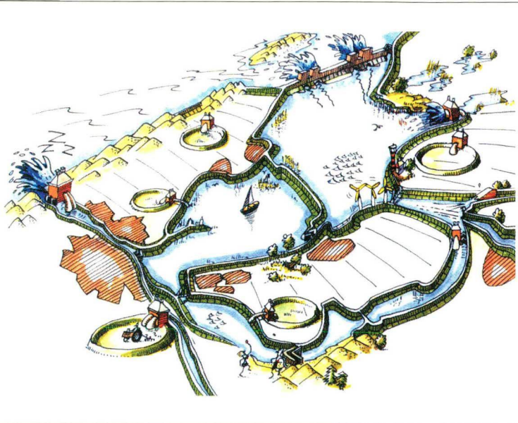
Vogelvluchtschets van de oplossingsrichting 'water verticaal bergen'. (Bron: Beleidsverkenning Waterhuishouding in het Natte Hart)
