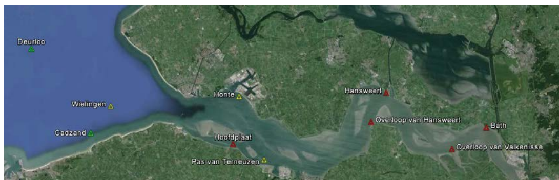
Figuur 2.28: Ligging van de meetstations voor de golfhoogte en -periode. Groen is een directional wave rider, rood is een golfbaak en geel is een boei.
