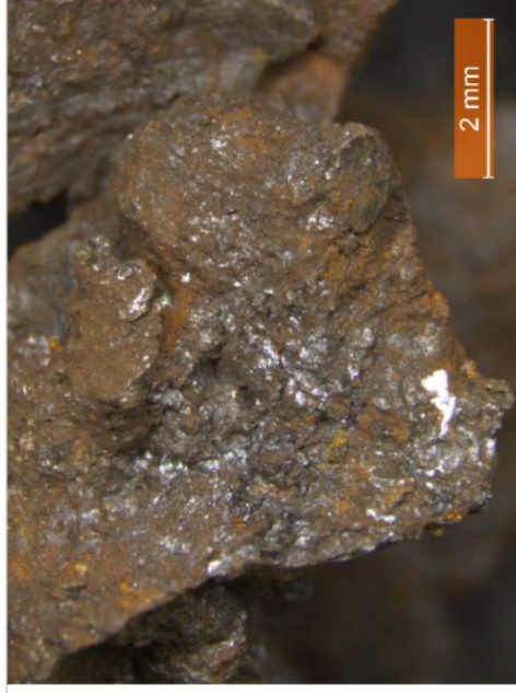
Foto B3. Microfoto van monster 5-3. Dit monster vertoont een metallische glans met een antracietbruine kleur.
