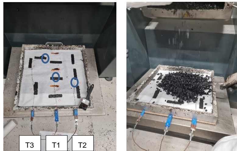
Figuur 6 Er zijn 3 thermokoppels (T1, T2, T3) op de bodem van de mal aangebracht ter validatie van de data afkomstig van de RFID temperatuursensoren. De blauwe cirkels refereren naar de positie van de thermokoppelsensoren. Een vierde thermokoppel T4 (niet weergegeven) is ca 2,5 cm boven T1 geplaatst, halverwege de asfaltplaat.
