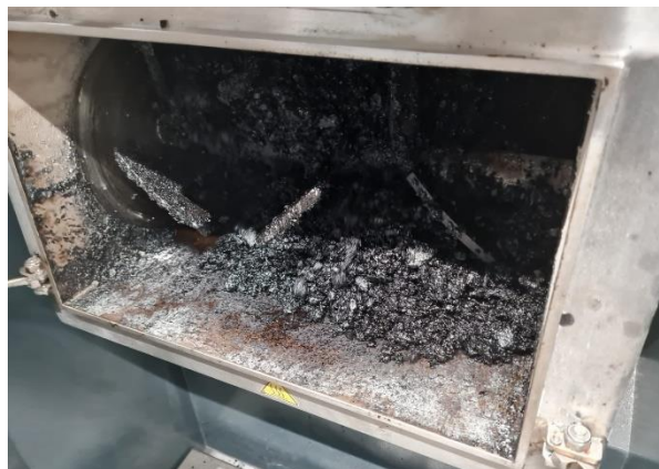
Figuur 3 Batchmixer, zoals gebruikt voor het mengen van de asfaltmengsels
