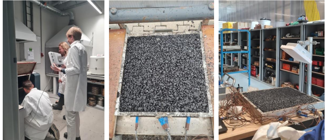
Figuur 7 Temperatuurmonitoring tijdens de asfaltproductie (links en midden) en tot 4 uur van het afkoelen (rechts).
