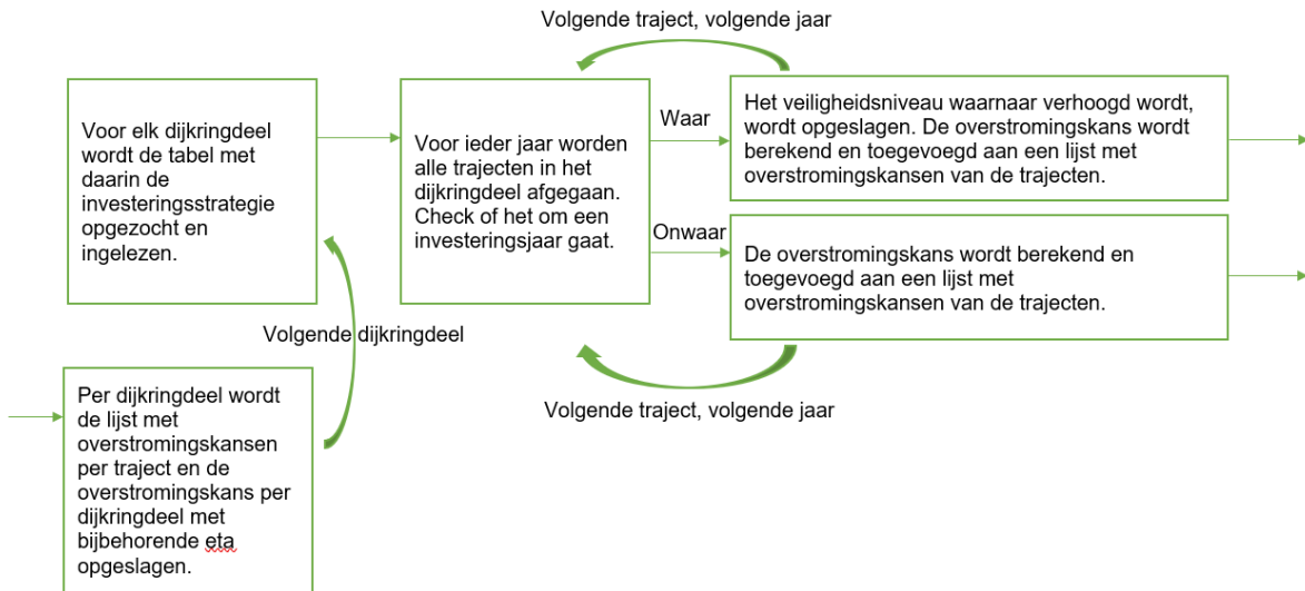
Figuur 2: Schematische weergave van het berekenen van de overstromingskansen in het programma "Berekening_economisch_optimale_overstromingskansen.py"
