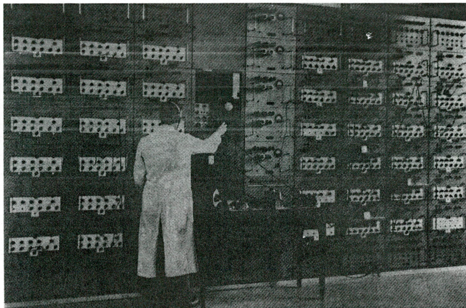
Afb. 7. Gedeelte van de elektrische analogon-rekenmachine, de zogenaamde Deltar, voor het bestuderen van de waterbeweging in het Deltagebied.
