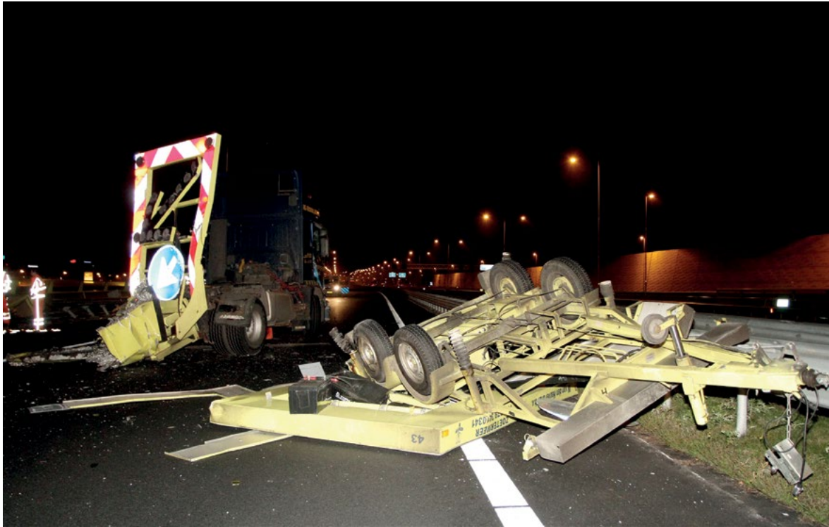
Figuur 38: De omver gereden pijlwagen met op de achtergrond de botsabsorber, die voor de pijlwagen heeft gestaan. Bron: Bart Meesters/Meesters Multimedia.
