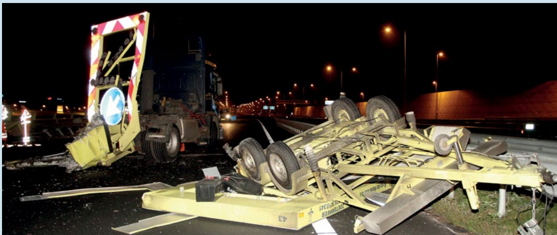
Figuur 6: De omver gereden pijlwagen met op de achtergrond de botsabsorber, die voor de pijlwagen heeft gestaan. Bron: Bart Meesters/Meesters Multimedia.
