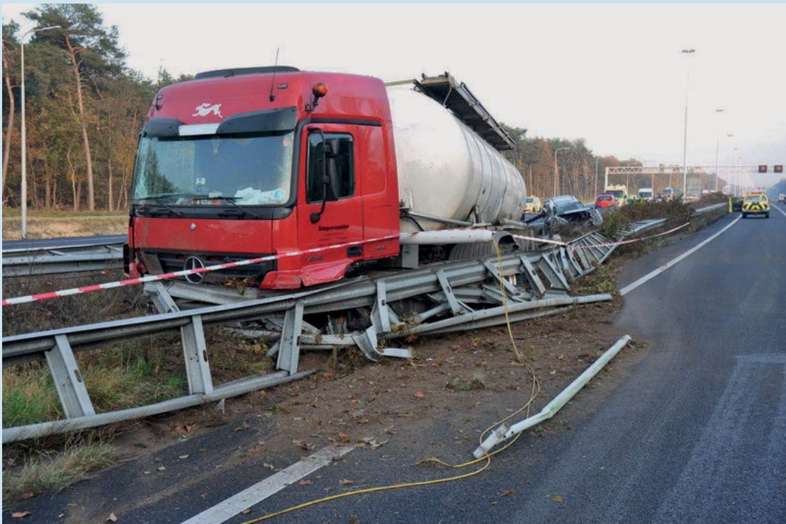
Figuur 13: De vrachtwagen is door de middenbermvangrail gereden en bijna op de tegenoverliggende rijbaan tot stilstand gekomen. Bron: politie.
