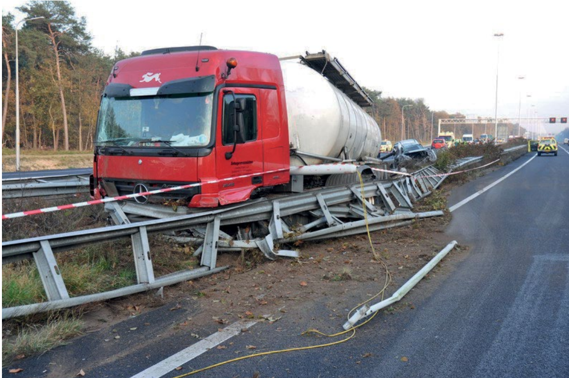
Figuur 35: De vrachtwagen is door de middenbermvangrail gereden en bijna op de tegenoverliggende rijbaan tot stilstand gekomen. Bron: politie.
