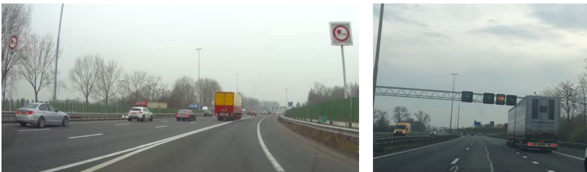
Afbeelding 38 en 39: aanduiding IVV middels wisselbord (A13) en middels signaalgever (A2)
