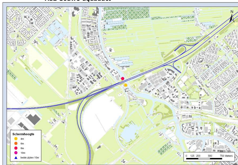
Figuur B4.19: E Toetspunten waar luchtschermen benodigd zijn bij restdag 130km/uur: A12 Gouwe-aquaduct
