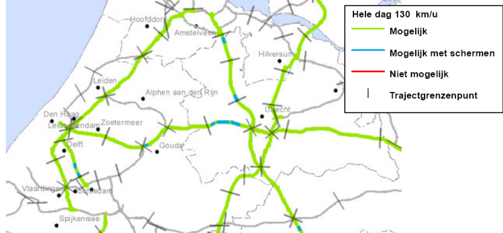
Figuur 4.3: Uitsnede resultaten optimalisatievariant hele dag 130 km/uur
