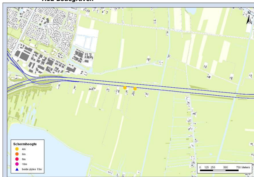
Figuur B4.6: F Toetspunten waar luchtschermen benodigd zijn bij permanent 130km/uur: A12 Bodegraven
