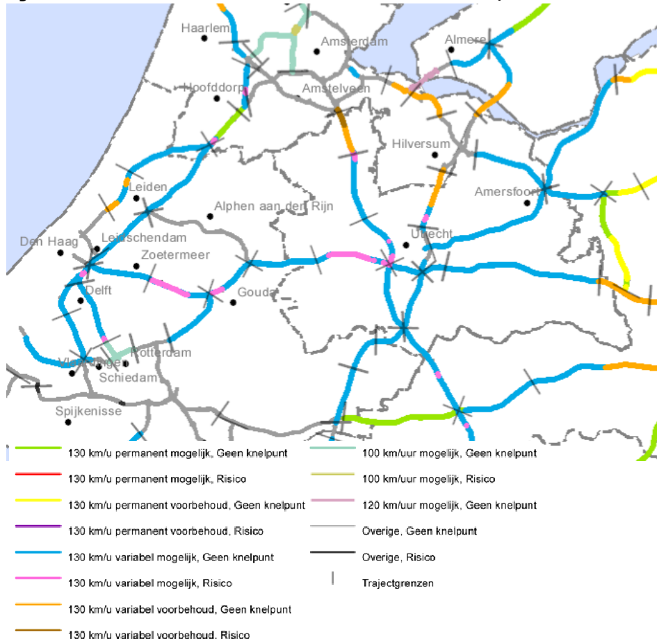
Figuur 4.2: Met name in de Randstad is het doorvoeren van 130 km/uur variabel veelal mogelijk.
