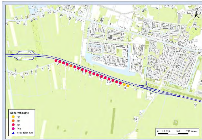
Figuur B4.8: H Toetspunten waar luchtschermen benodigd zijn bij permanent 130 km/uur: A12 De Meern
