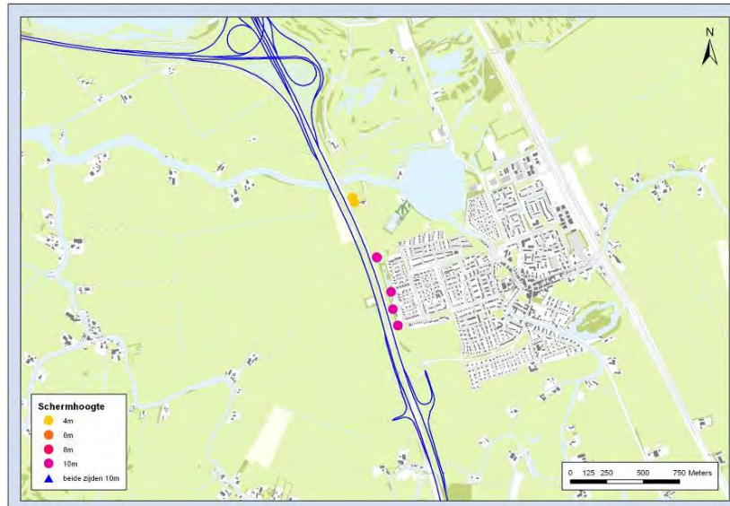
Figuur B4.1: A Toetspunten waar luchtschermen benodigd zijn bij permanent 130km/uur: A2 Abcoude
