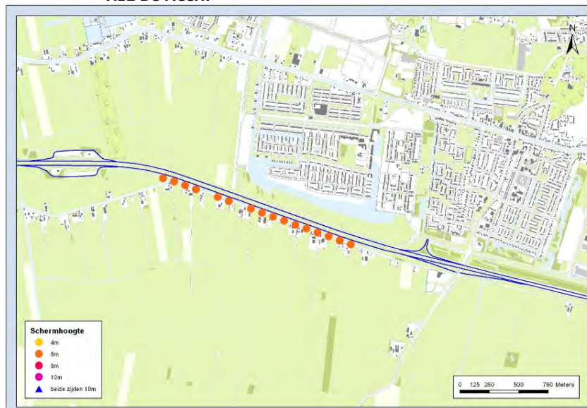
Figuur B4.21: H Toetspunten waar luchtschermen benodigd zijn bij restdag 130km/uur: A12 De Meern
