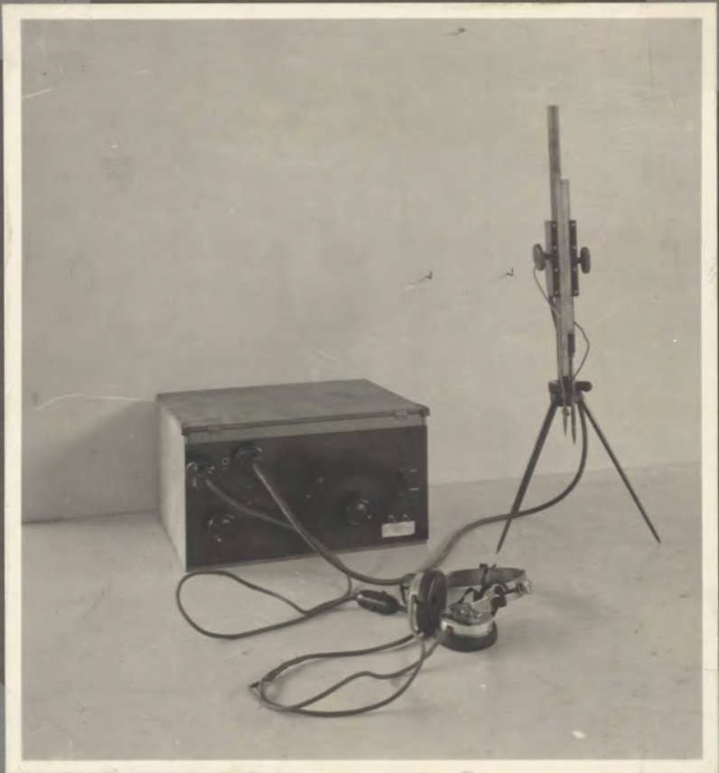
8. Het toestel voor het meten der golfhoogten.
