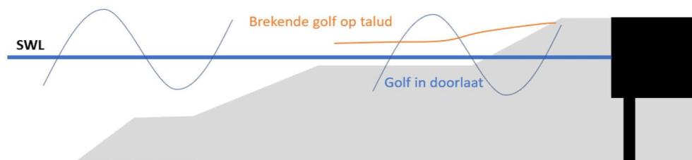
Figuur 6-11 Golfoploop op talud en golf in doorlaat VMR
