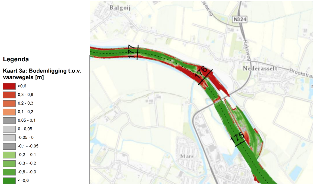
Figuur 2 Voorbeeld ondiepte bij de sluizen bij stuw Grave in de Maas, km 176 (rode zones zijn te ondiep volgens de vaarwegeisen)
