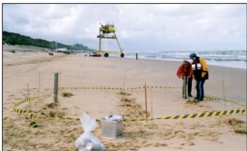
Figuur 1: Bemonstering van het strand met steekbuisen. Op de achtergrond de WESP die werd gebruikt voor bemonstering van de brandingszone en het diepere water (Foto: G.M. Janssen).
