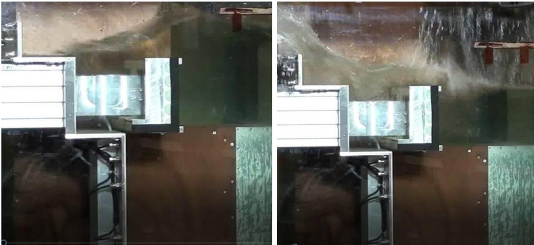
Figuur 11: golven die breken op de defensiebalk en dan doorschieten naar het spatscherm
