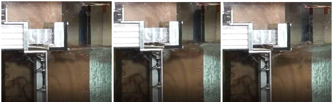
Figuur 15: effect spleet op wegzakken water niveau onder de defensiebalk
