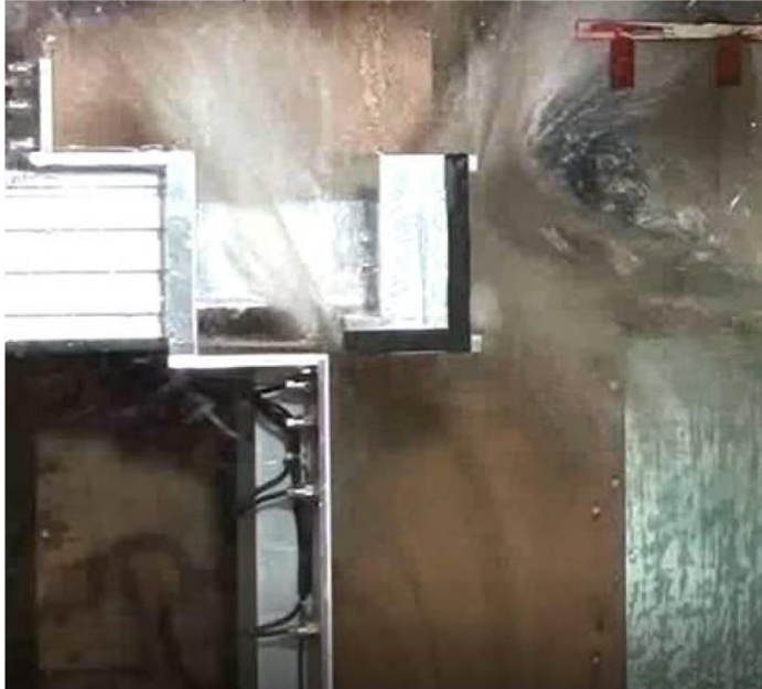
Figuur 14: klap op onderkant defensiebalk met wegschietend water
