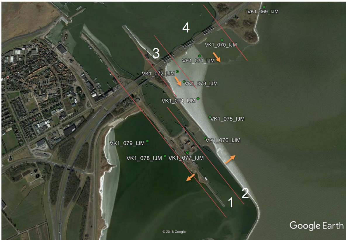
Figuur 1.1 Dijkvakindeling (rood) en uitvoerlocaties bij Den Oever. De oranje pijlen geven de gebruikte dijkoriëntatie weer.
