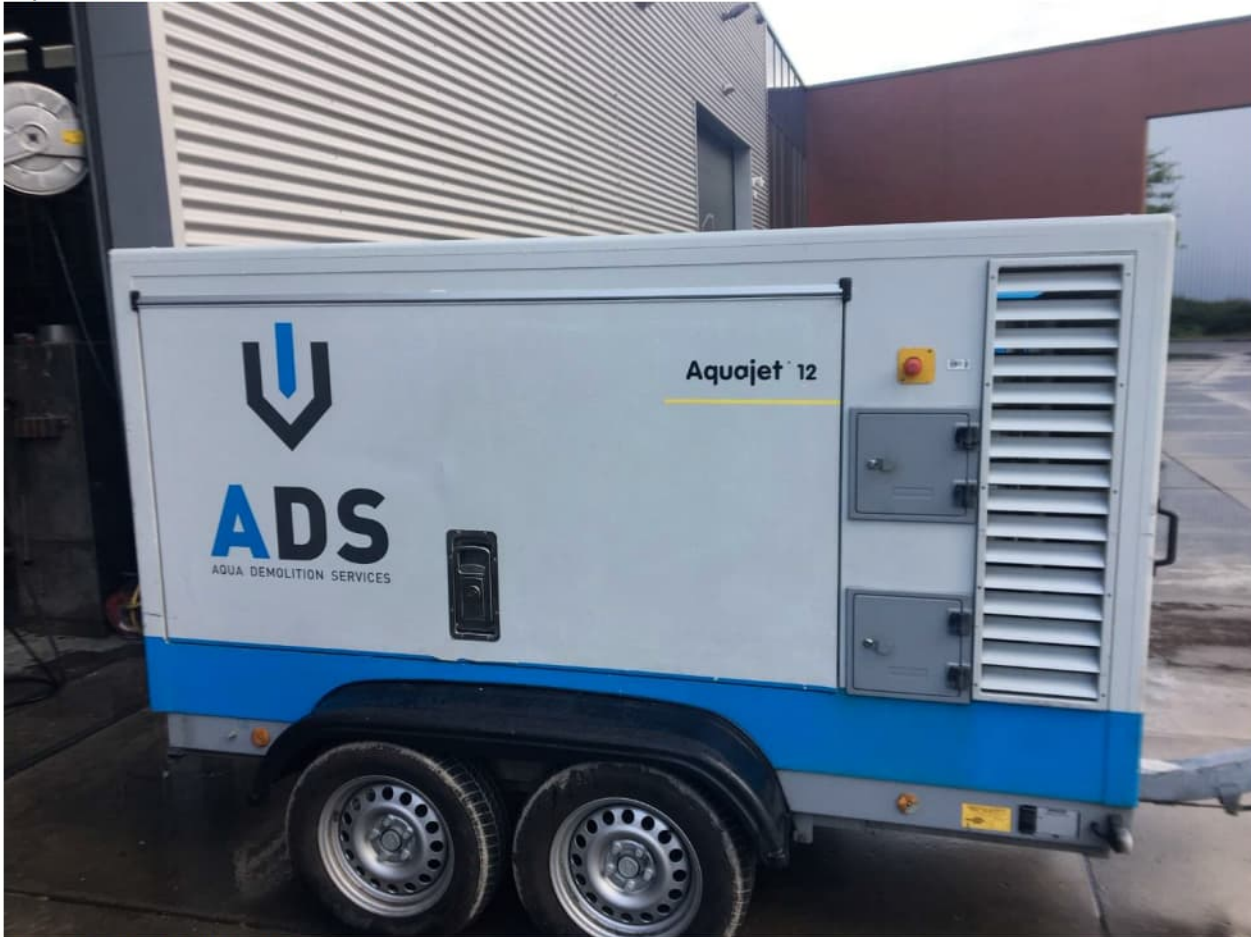
Afb.: in te zetten Hydrodemolition pomp
