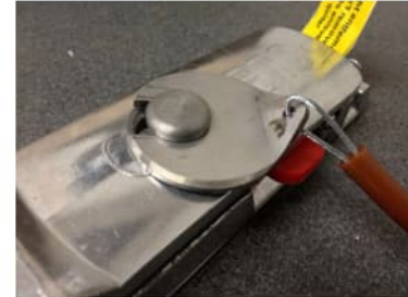
Afb. 22 Juist plaatsing van het 'muntje'. Het lipje bij de kabelbevestiging moet naar boven wijzen.
