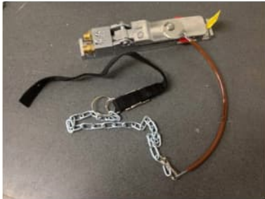
Afb. 21 Afstandsbediening met muntje en verbinding voor bevestiging aan arm
