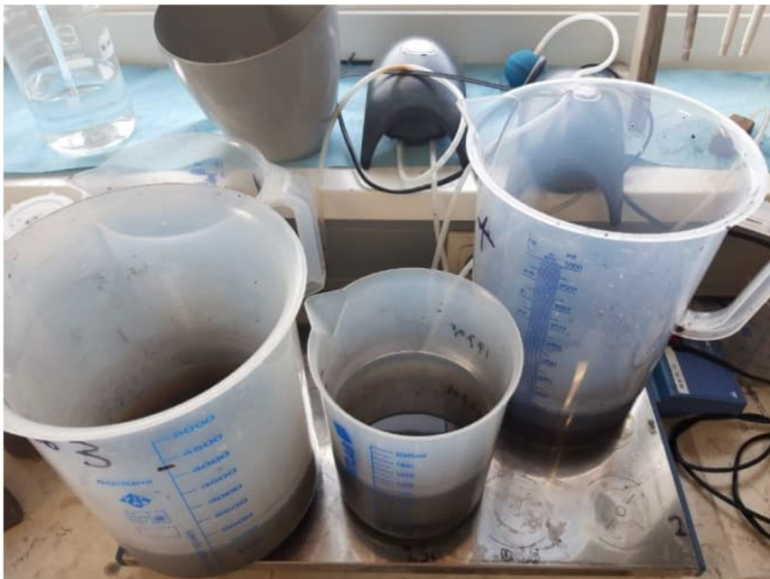
Figuur 2: De maatbekers met vier samples tegelijkertijd (onbelucht). De beluchters staan in de vensterbank (incl. beluchtungssteentjes).
