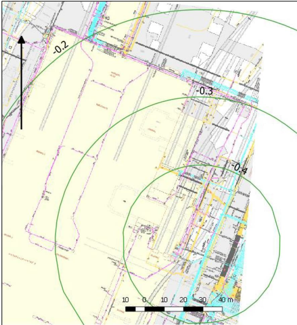
Figuur 4 PS121 actief op de huidige circa 20 m 3 /uur. PS120 staat uit.
