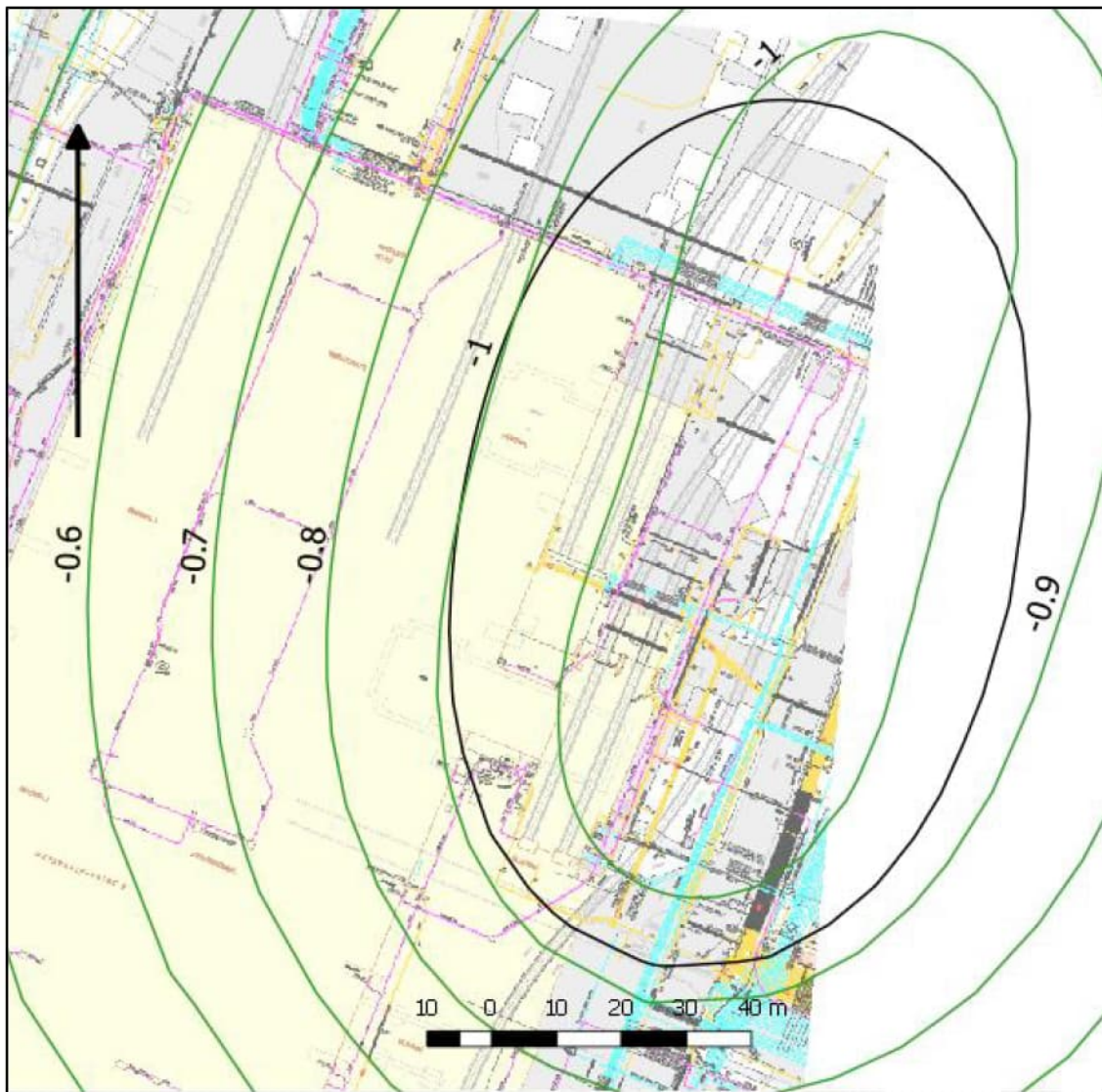
Figuur 3a twee bronnen actief. PS121 op 30 m 3 /uur, in groen met nieuwe bron (PS122a, 30 m 3 /uur) en in zwart de 1 m verlagingcontour huidige bron (PS120, 30m 3 /uur en PS121 op 30m 3 /uur).
