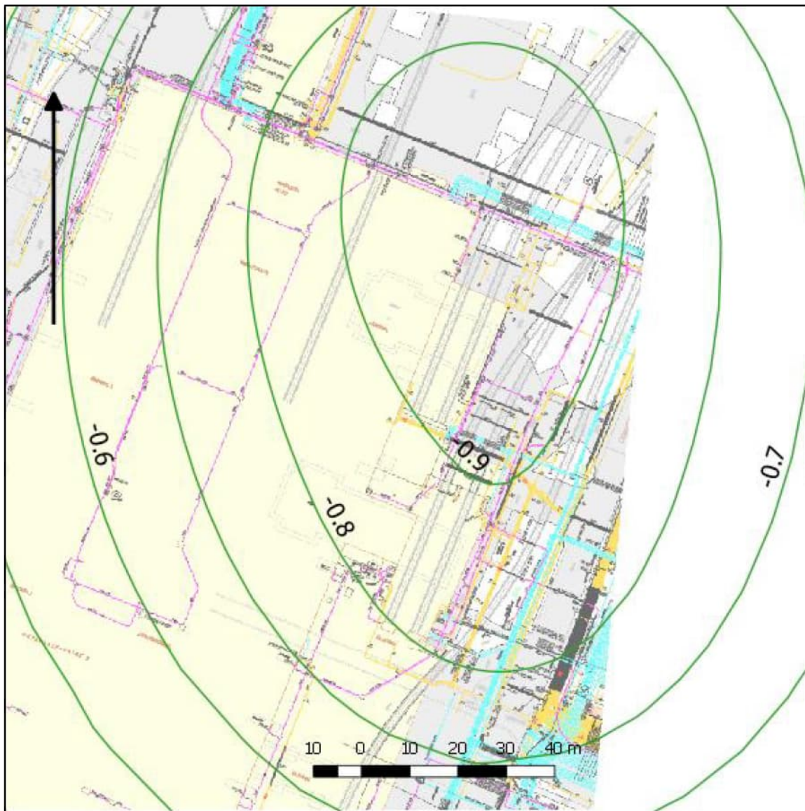
Figuur 5b PS121 actief op de huidige 20 m 3 /uur en de nieuwe PS122b op 30 m 3 /uur.
