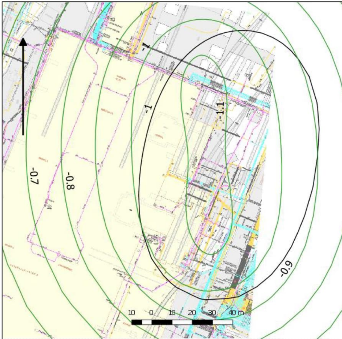
Figuur 3b twee bronnen actief. PS121 op 30 m 3 /uur, in groen met nieuwe bron (PS122b, 30 m 3 /uur) en in zwart de 1 m verlagingcontour huidige bron (PS120, 30m 3 /uur en PS121 op 30m 3 /uur).
