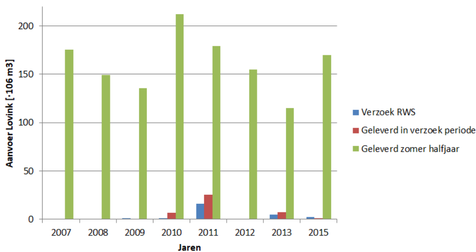
Figuur 4.24 Uitsplitsing van het pompdebiet van gemaal Lovink naar reguliere inzet gedurende de zomermaanden in vergelijking met de watervraag van de RMO (verzoek van RWS) en de daadwerkelijk geleverde aanvoer van gemaal Lovink in dezelfde verzoekperiode. Tijdens de wintermaanden zijn geen verzoeken geweest en deze (ONDJFM) zijn buiten beschouwing gelaten.+
