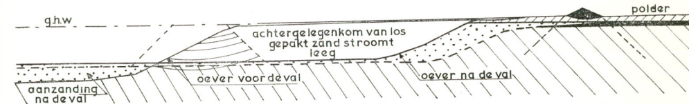
fig. 71. Reconstructie van een oeversval.
