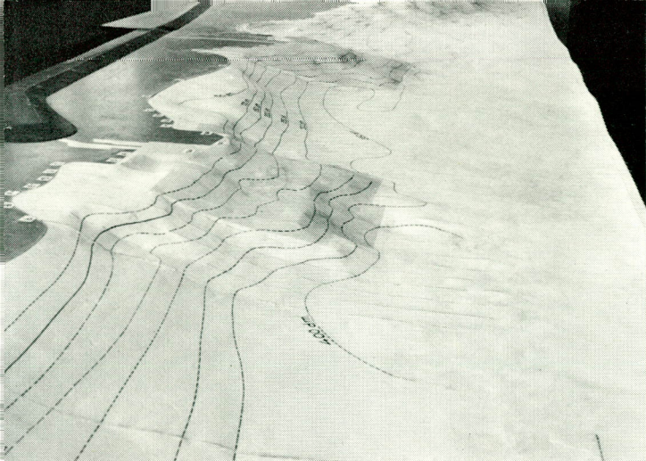
fig. 180. Maquette van de oever en de oeververdediging langs de Oud-Kempenshofstedepolder op Tholen (langs het Mastgat).
