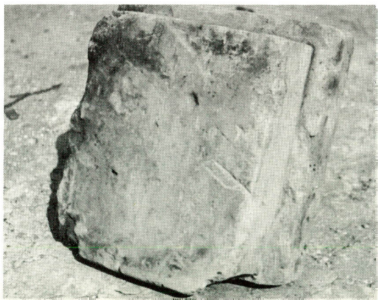
fig. 187. Gebakken glooiingsteen, z.g. „Cormansteen” in het begin van de vorige eeuw gefabriceerd door de steenbakker Corman te Gendt bij Nijmegen.
