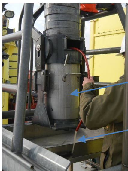
Figuur 1. Reineck box corer (naamgeving leverancier Standaard Box Corer)
