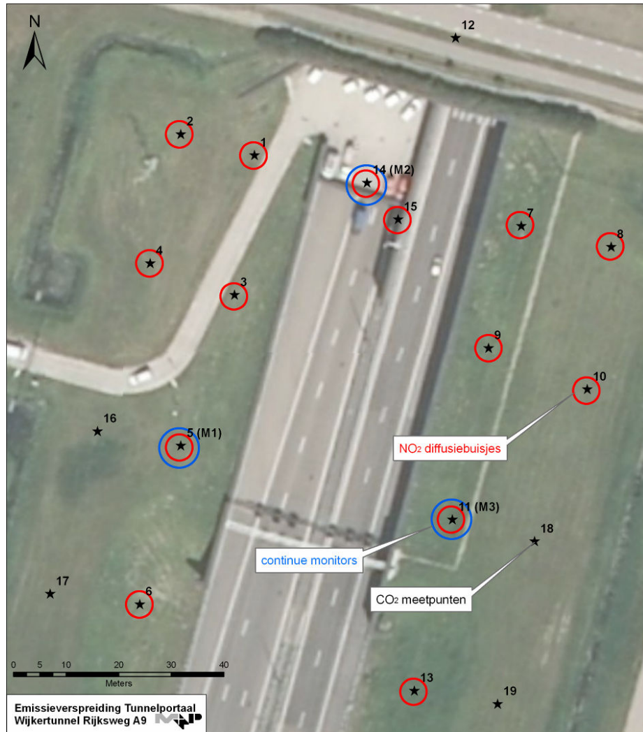
Figuur 2: Meetopstelling tunnelportaal A9
