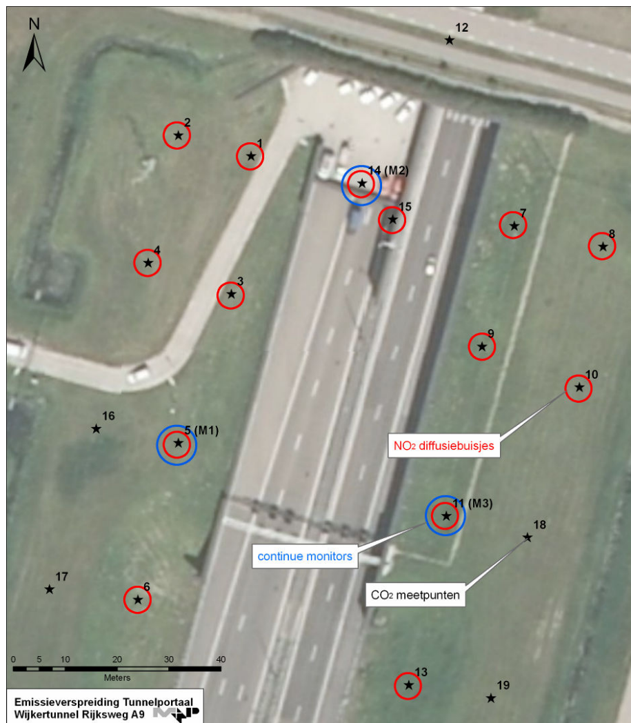
Figuur 2: Meetopstelling tunnelportaal A9
