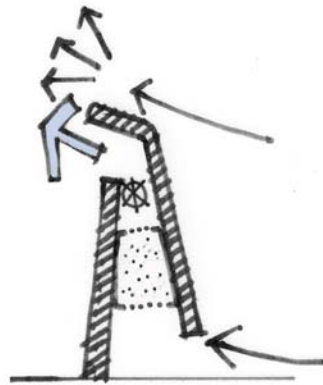
Ballenbak met mechanisch aangedreven stroming
