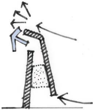
Ballenbak met windaangedreven stroming
