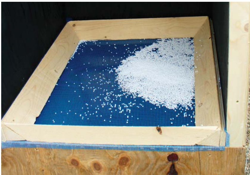
Ballenbak bestaat uit gaas en polystyreenkorrels
