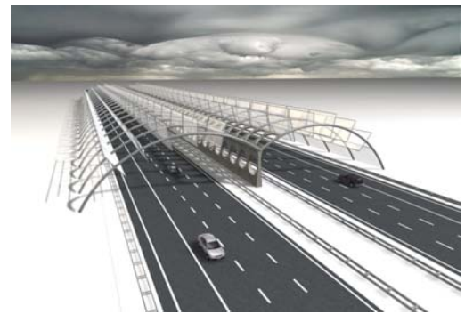
figuur: DHV/NIO: opgeblazen kussens van ethyleentetrafluorethyleen; ETFE
