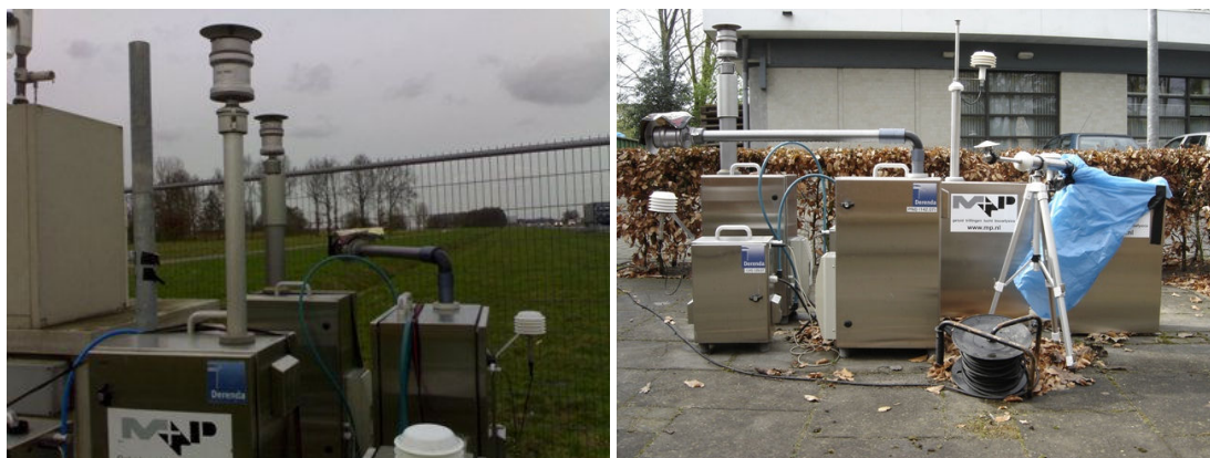
figuur 23 Meetopstelling onderzoek horizontale inlaat op een LVS in de proeftuin "Schermen" (links) en op de binnenplaats van M+P in Vught (rechts)
