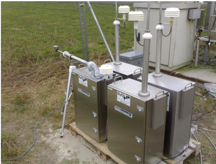
figuur 13 Opstelling vergelijkende meting met een horizontale inlaat op GRIMM 1
