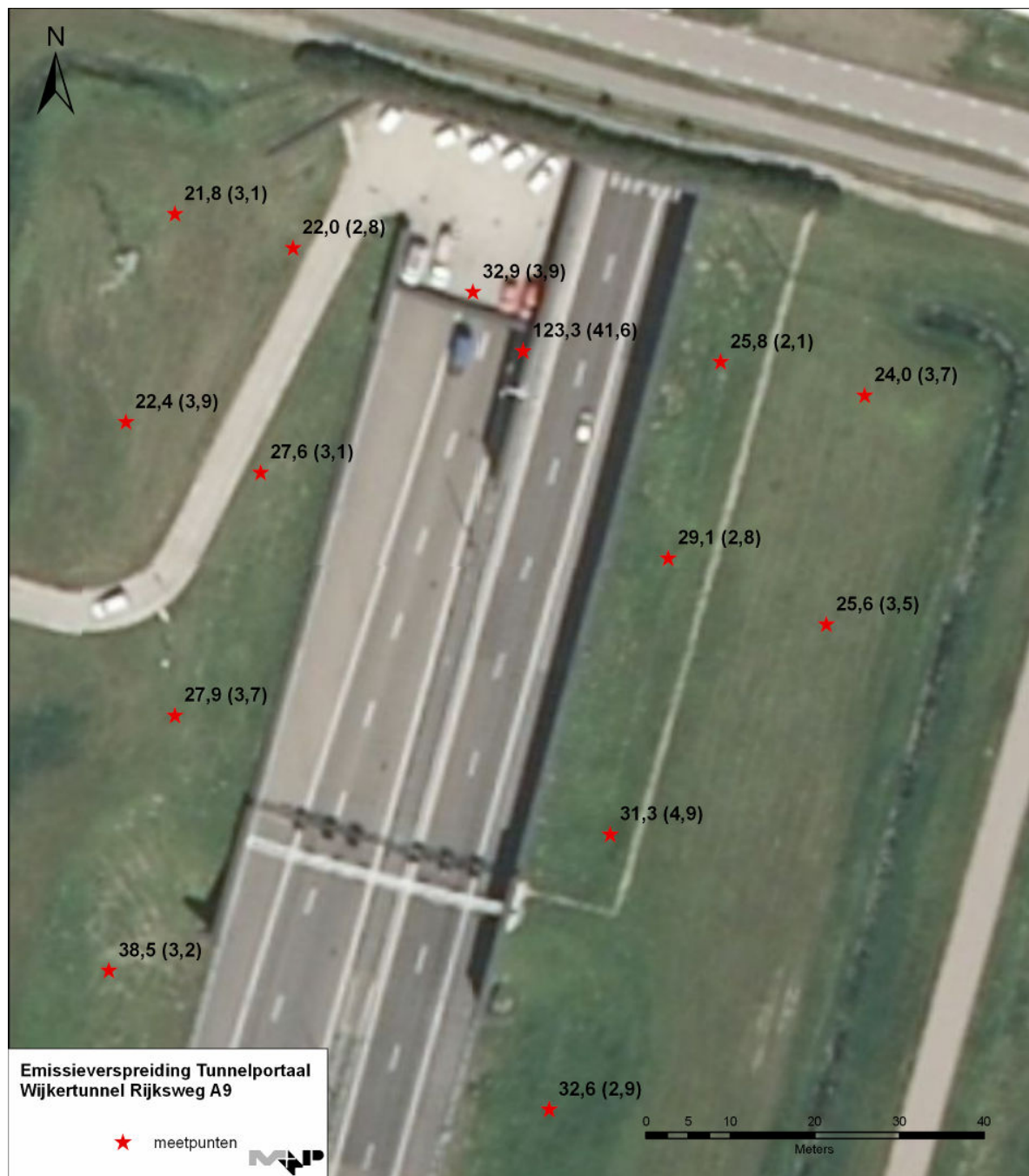
figuur 20 Gemiddelde concentratie NO 2 in µg/m 3 over de gehele meetperiode per meetlocatie met de standaarddeviatie tussen haken voor Palmes diffusiebuisjes
