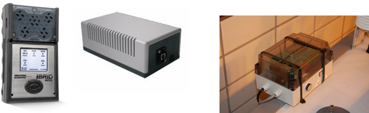
figuur 8 CO 2 meetapparatuur van links naar rechts: IBRID MX6, Klimabox CaTeC en Europa monitor
