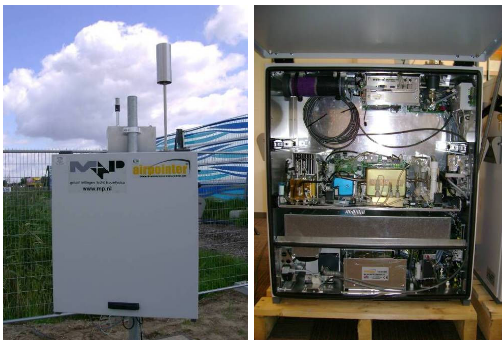
figuur 6 \text{NO}_x , \text{NO}_2 , meetapparatuur: Airpointer
