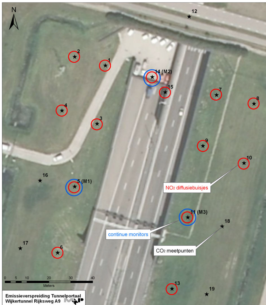
figuur 4 Meetopstelling tunnelportaal Rijksweg A9
