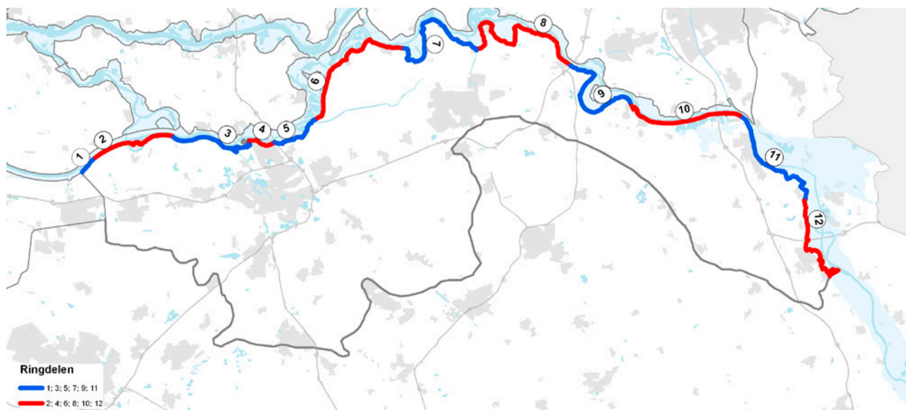
Figuur 3. Voorbeeld van een onderverdeling van de dijkkring in ringdelen: de onderverdeling van dijkkring 36 Land van Heusden/de Maaskant in 12 ringdelen.
