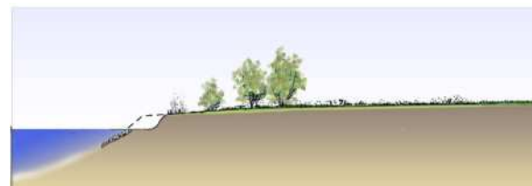
Figuur 11. Aanleg situatie natuurvriendelijke oever (schematische/indicatieve weergave) (bron: activiteitenplannen van Royal HaskoningDHV, 2013).
