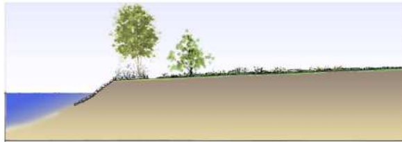
Figuur 10. Aanleg situatie natuurlijke oever (schematische/indicatieve weergave) (bron: activiteitenplannen van Royal HaskoningDHV, 2013).
