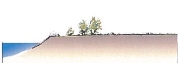
Figuur 3: Aanleg situatie natuurlijke oever met gedeeltelijke verwijdering van stortsteen (schematische/indicatieve weergave)
