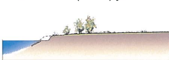
Figuur 3: Aanleg situatie natuurlijke oever met gedeeltelijke verwijdering van stortsteen (schematische/indicatieve weergave)
