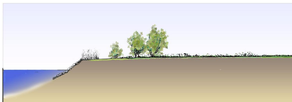
Figuur 2: Aanleg situatie natuurlijke oever met gedeeltelijke verwijdering van stortsteen (schematische/indicatieve weergave)
