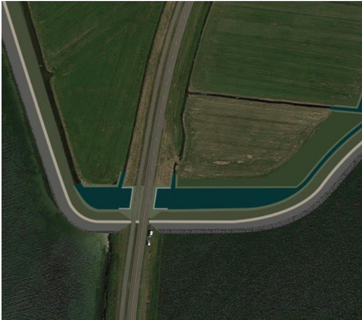
Figuur S.5 Voorbeeld van integraliteit; bij de aansluiting Verbindingsweg worden zuidkade en westkade in één lijn gelegd, en krijgt de westkade in het deel tussen west en bocht dezelfde hoogte als de zuidkade opdat de bezoeker van Marken een helder beeld van de entree van het eiland krijgt. Dit principe geldt voor alle alternatieven.
