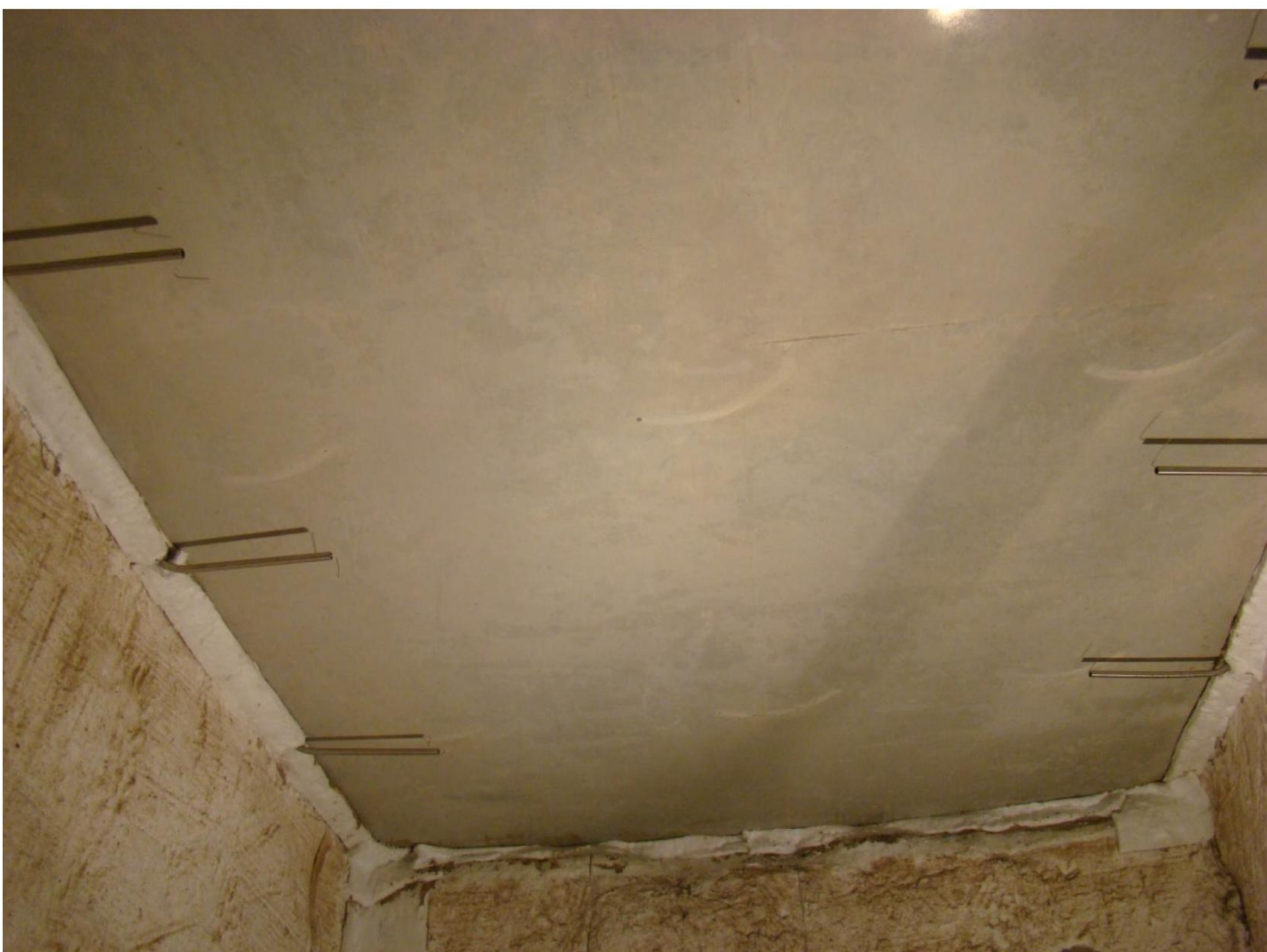
Foto 2: Verhit oppervlak voor de brandproef
