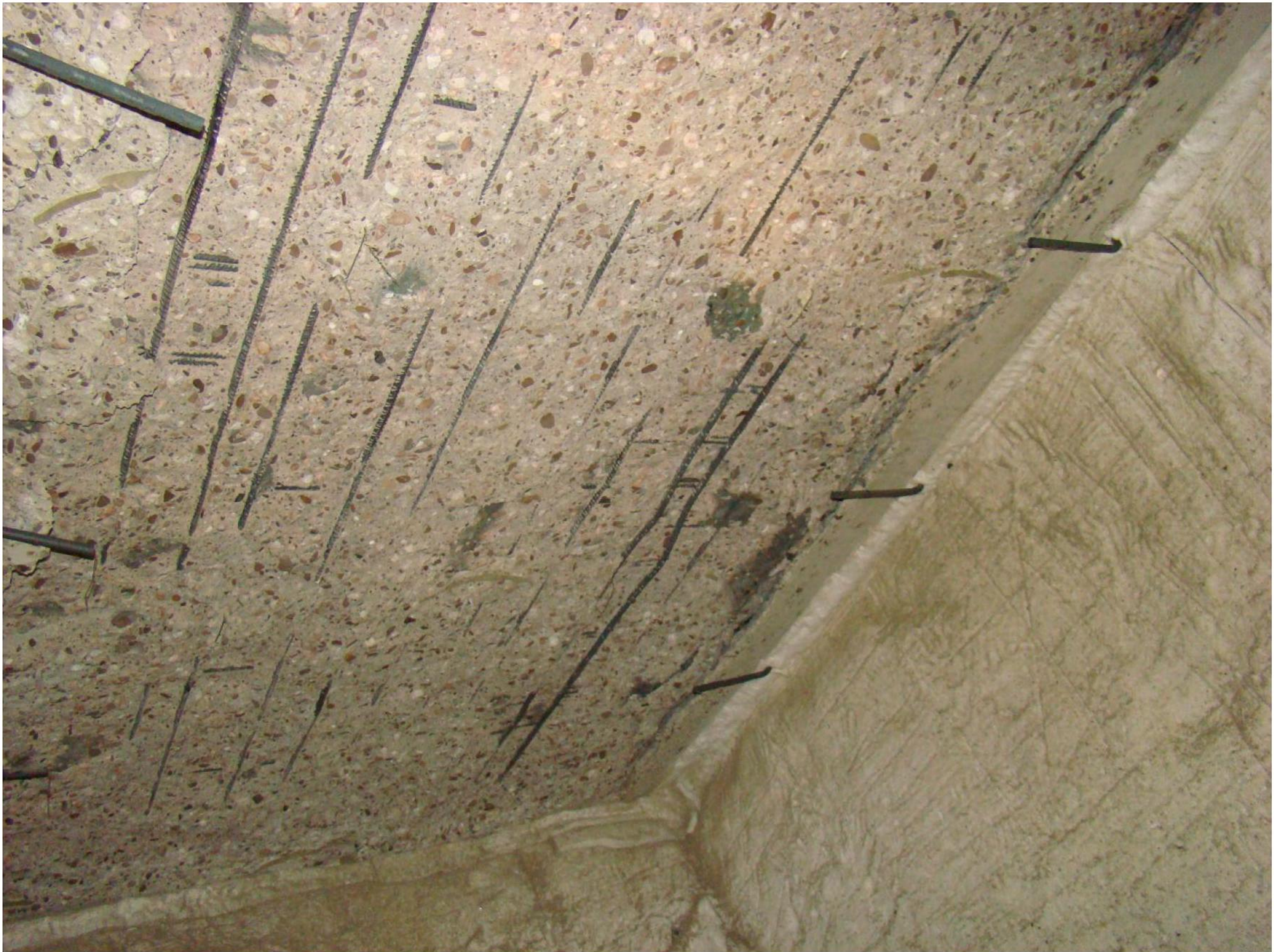
Foto 4: Verhit oppervlak na de brandproef
