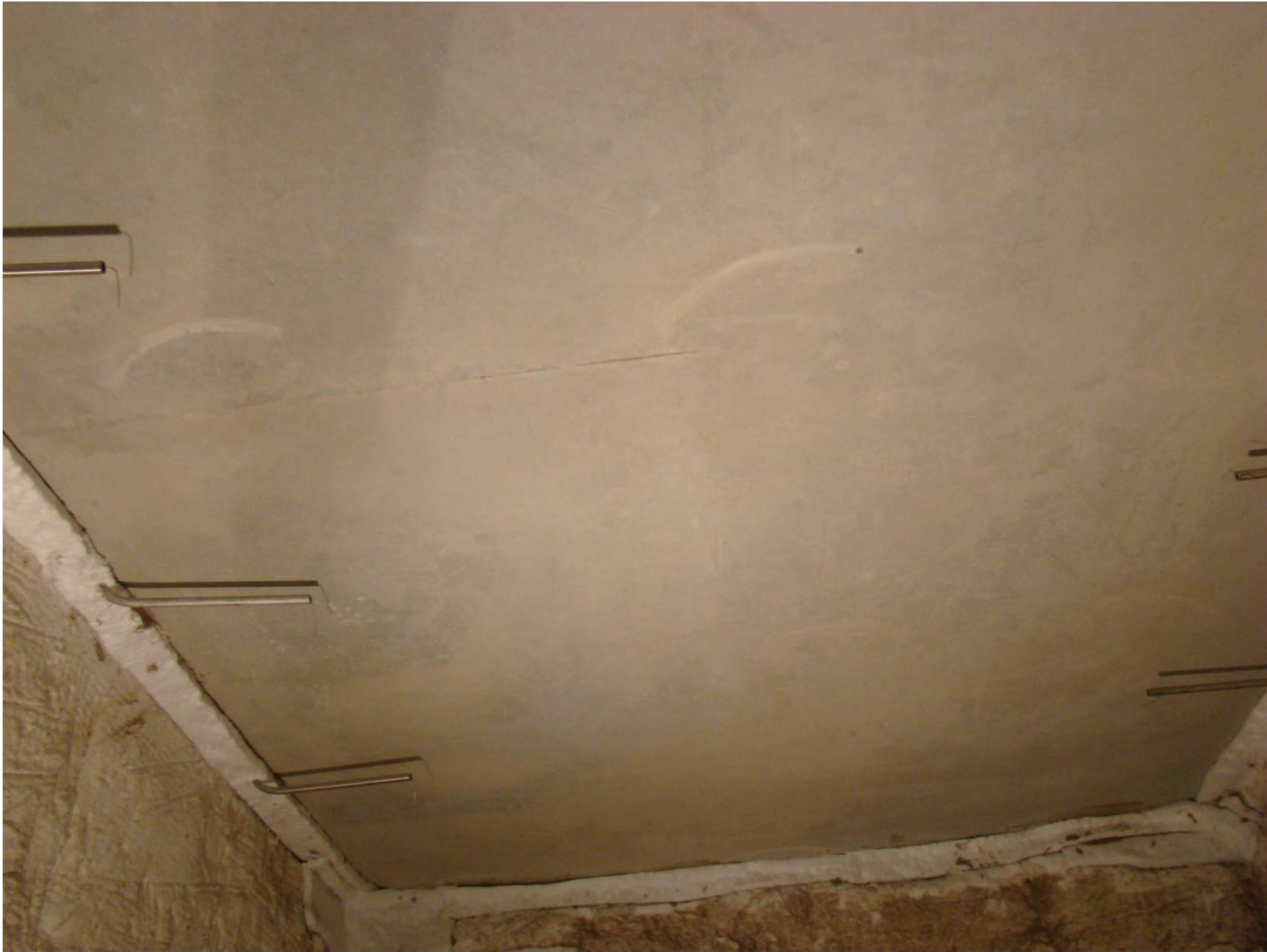
Foto 1: Verhit oppervlak voor de brandproef
