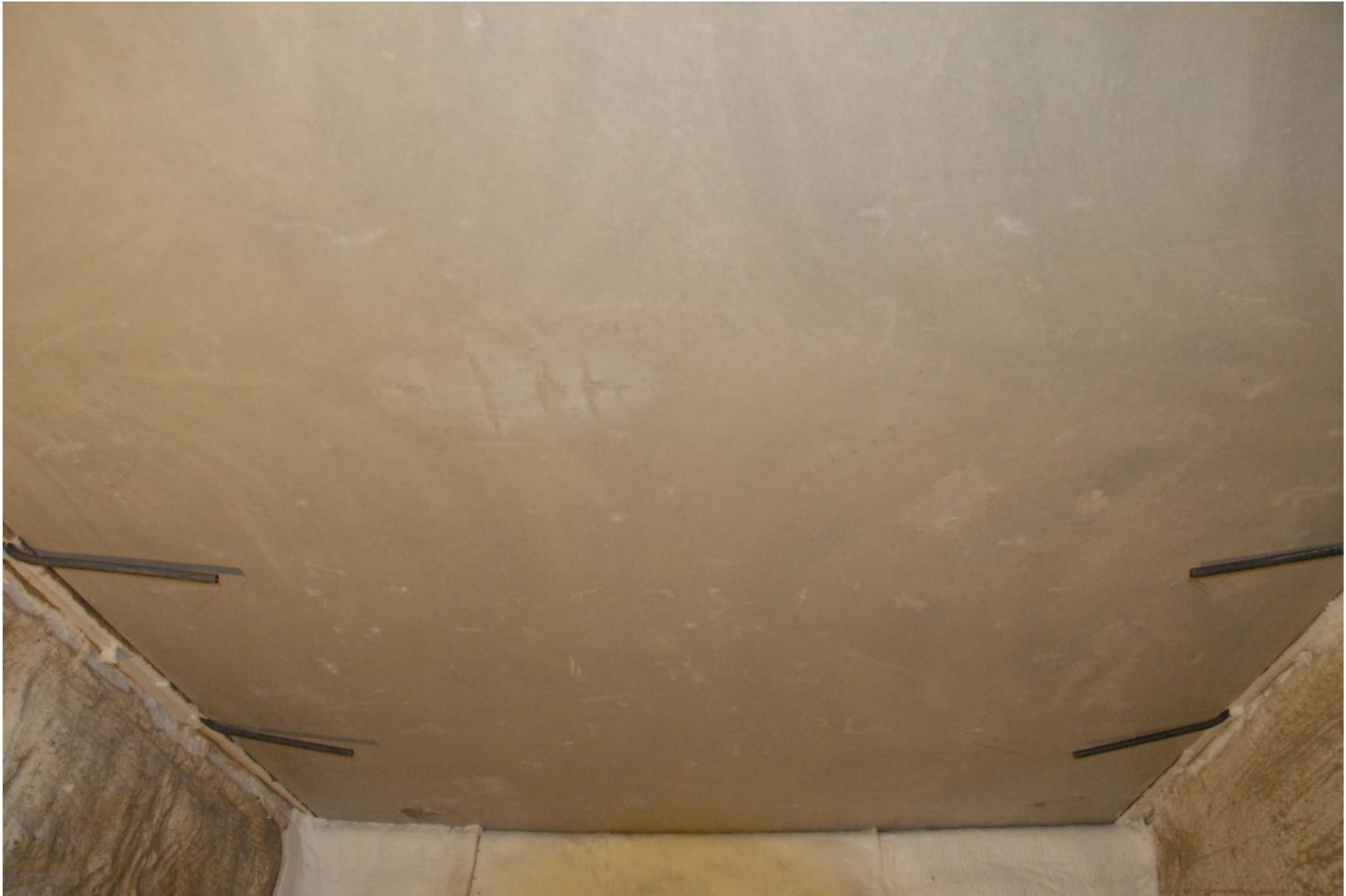
Foto 1: Verhit oppervlak voor de brandproef
