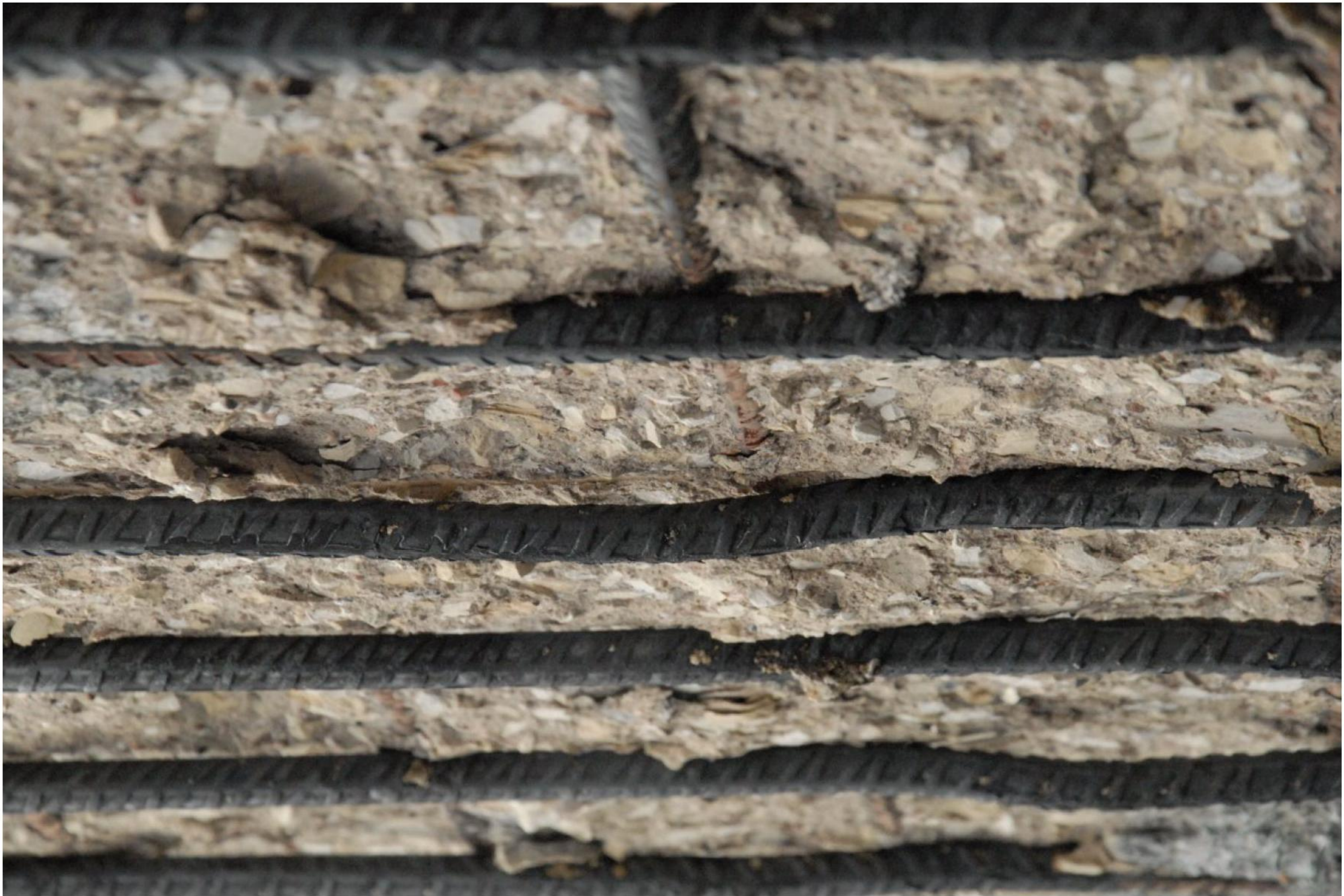
Foto 4: Details van het verhitte oppervlak na de brandproef
