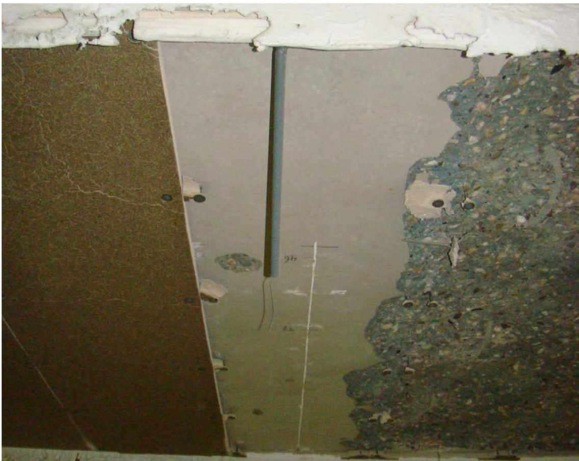
Foto 4: Details van het verhitte oppervlak na de brandproef
