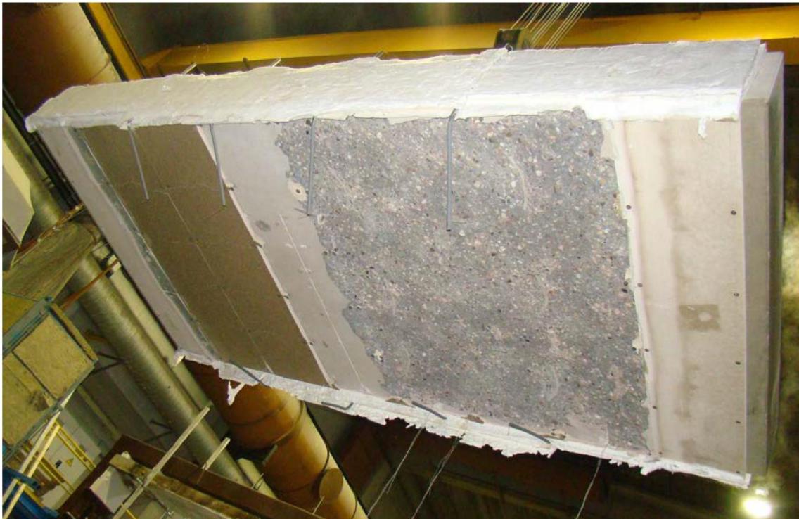
Foto 3: Verhit oppervlak na de brandproef
