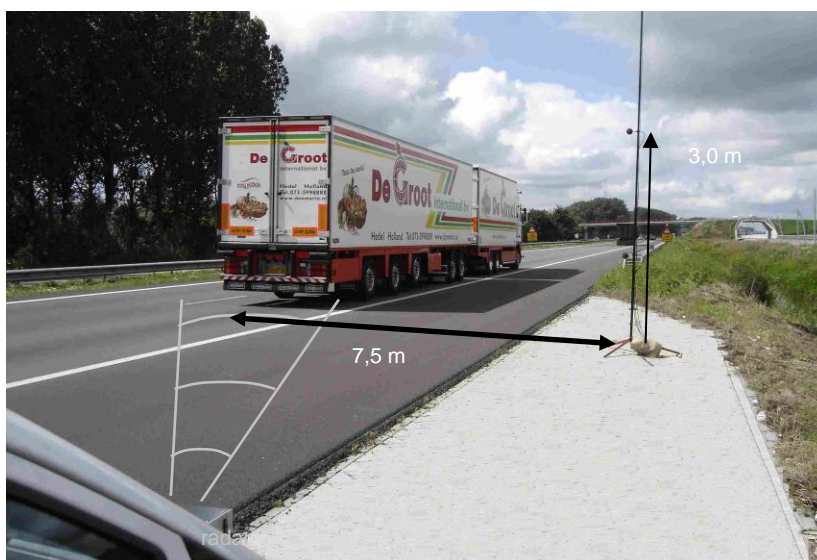
figuur 1 De standaard meetopstelling ter bepaling van het geluidniveau volgens de SPB-methode
