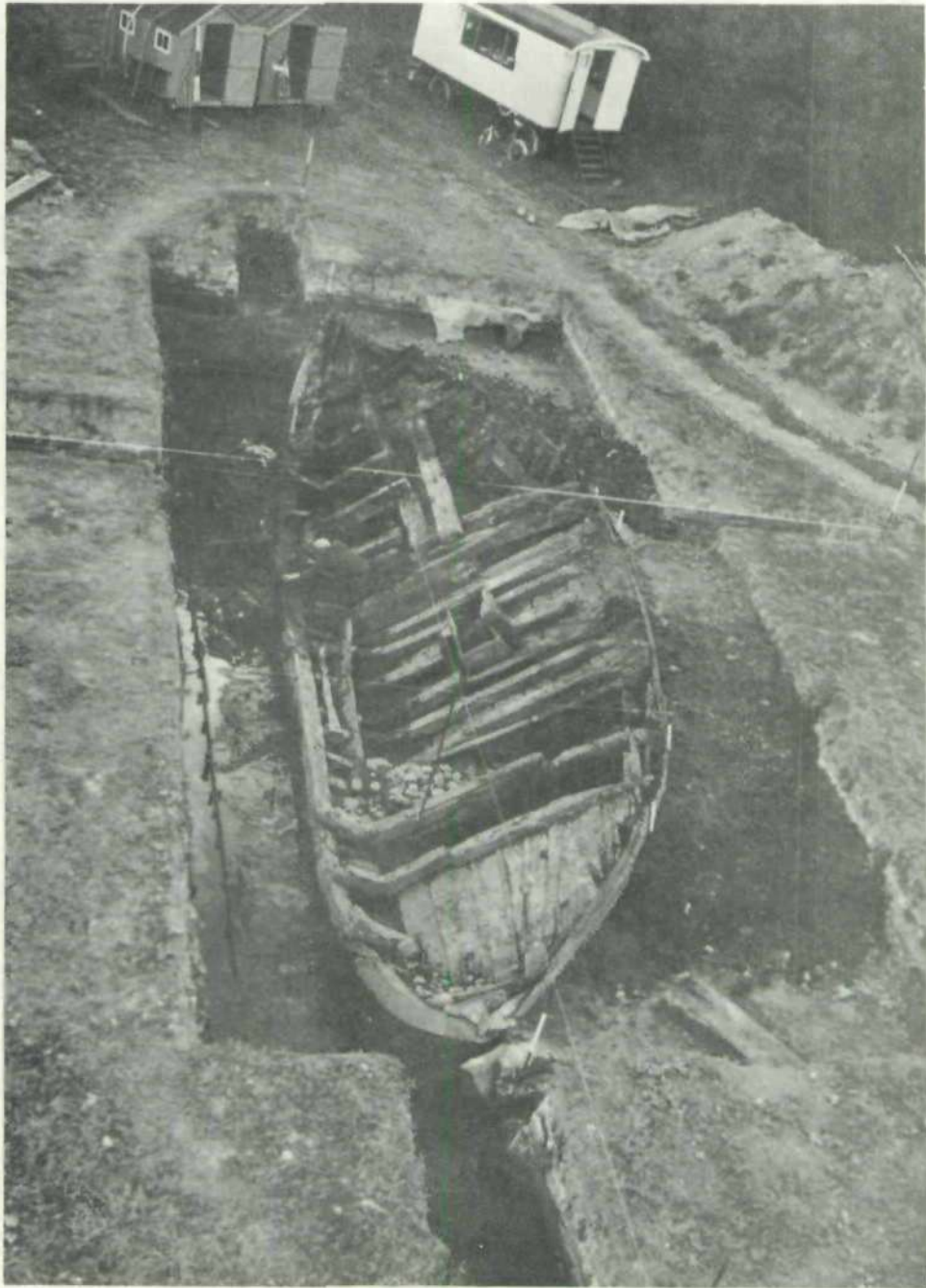
Het wrak K 84 nadat bijna alle binnenscheepse constructies verwijderd zijn en dus kiel, stevens en de huid van het schip geheel zijn waar te nemen.
