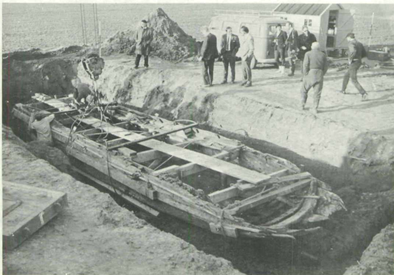
Het scheepswrak G 116, een klein ten dele karveel, deels overnaads gebouwd schip, werd overgebracht naar het museum te Ketelhaven.
