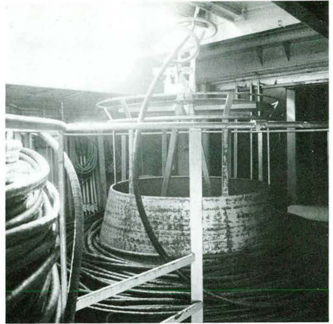
De buis in het ruim van de „Niveau”.
