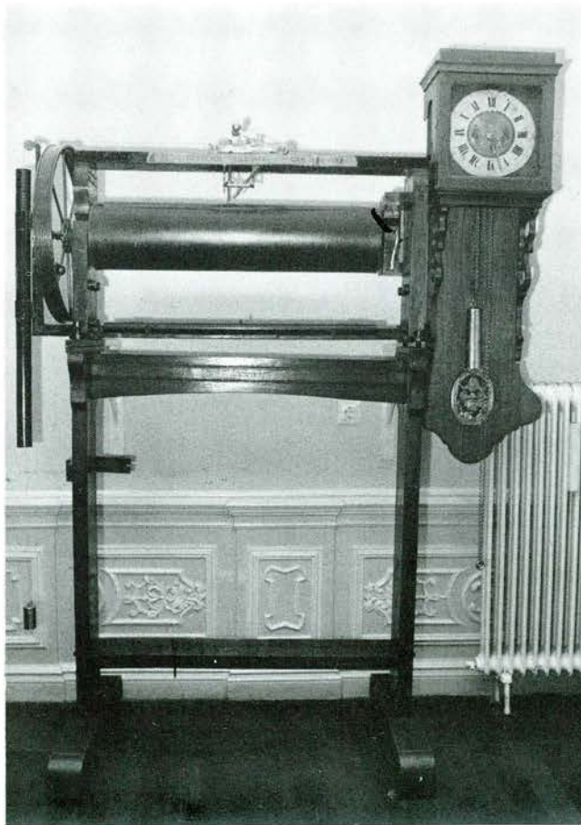
Het instrumentarium van het station Urk, in gebruik van 1858 tot in 1932. De trommel wordt aangedreven door de Friese staartklok.
