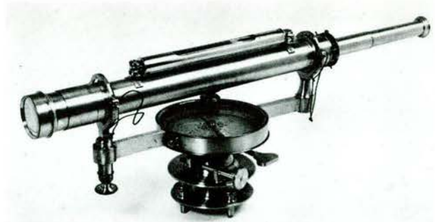
Het waterpasinstrument van Krayenhoff.
