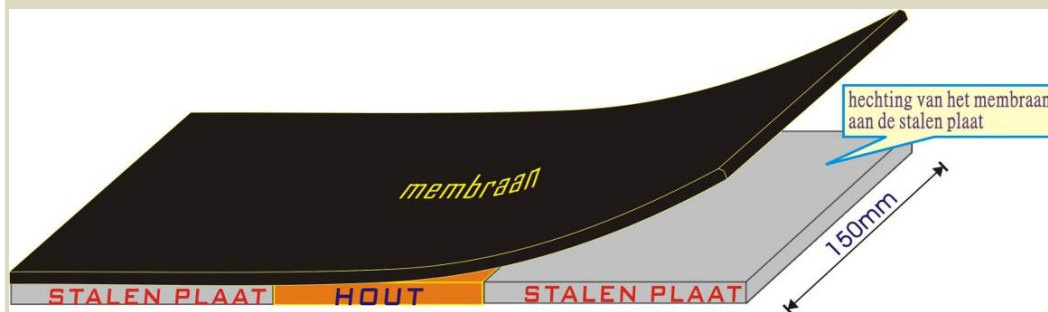
Figuur B7.4 Installatie van het membraan op de stalen plaat
