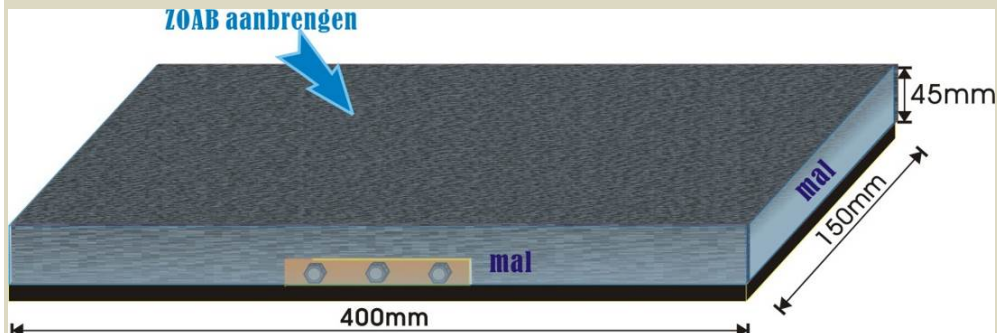
Figuur B7.13 Schematische voorstelling van een PM proefstuk
