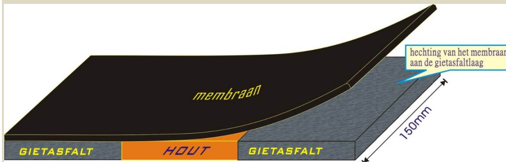
B7.10 Membraan-installatie op de bovenkant van GA
