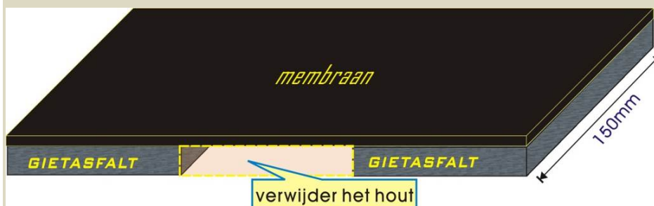
Figuur B7.11 Membraan op de bovenkant van GA proefstuk
