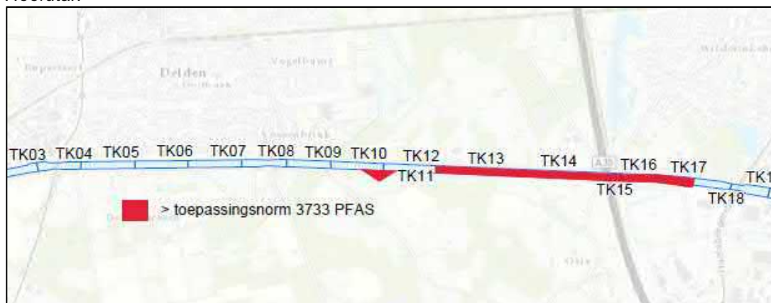
Figuur 8: Ligging vakken >Toepassingsnorm 3733 PFAS in 2 e laag vaste waterbodem in deellocatie Hoofdtak
