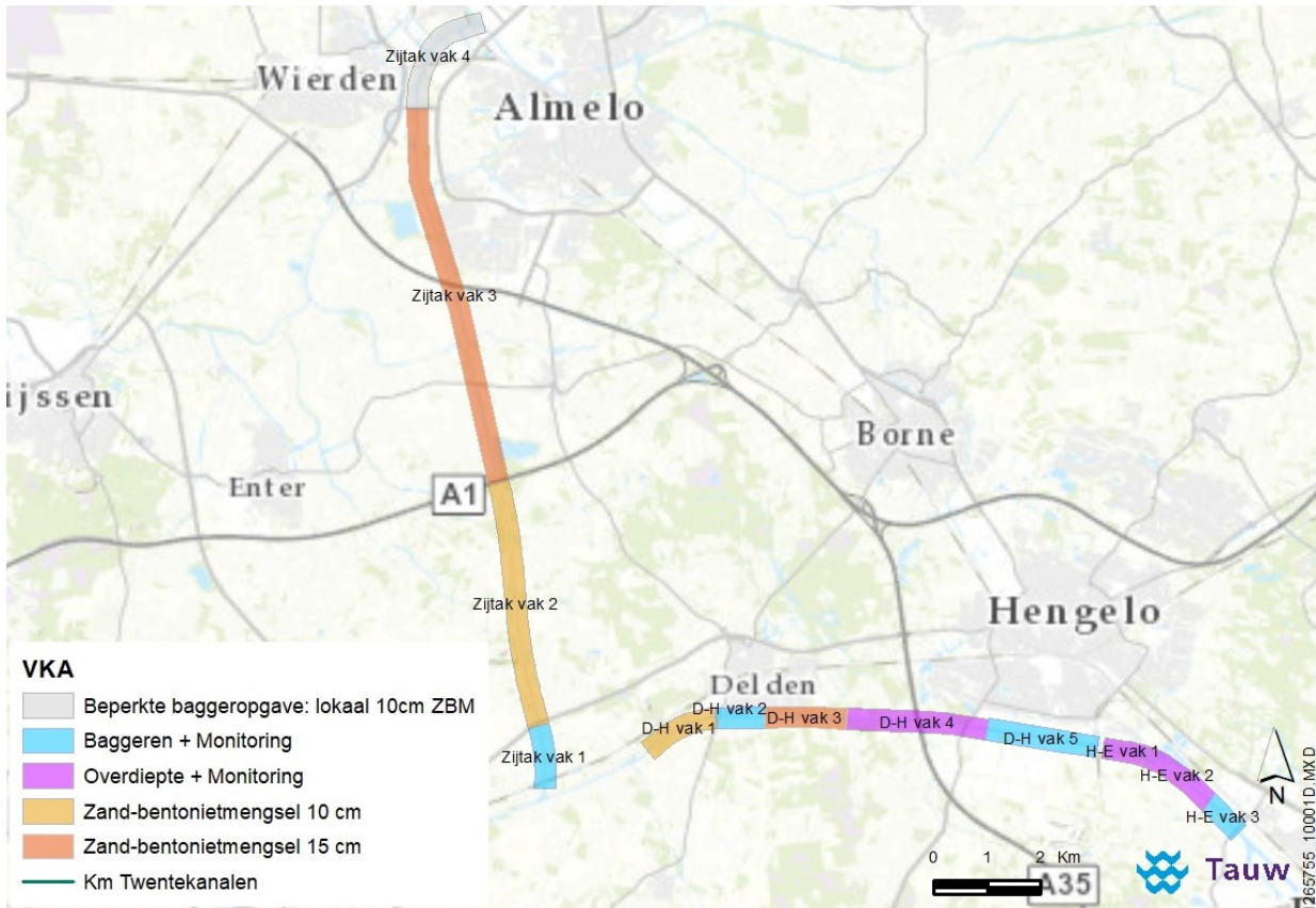
Figuur 3 Overzichtskartaal maatregelen grondwaterbeheersing Twentekanaal
