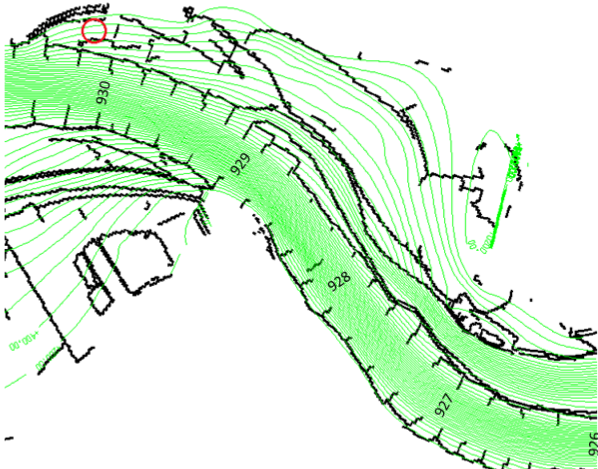
Figuur 6: Afvoertijnen (per 200 m 3 /s) afkomstig uit de resultaten van het WAQUA-model beno_18_5 voor de vergunde situatie.
