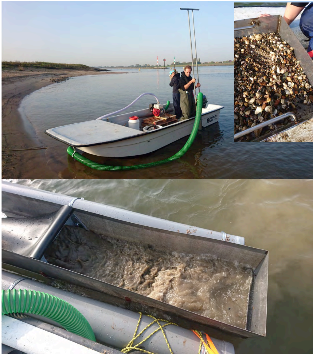
Figuur 2.3. Overzicht van de bodemzuiger waar de bodemmonsters mee zijn verzameld. Het zuigmondstuk van de zuiger wordt vanaf de boot met de hand bestuurd (boven), het opgezogen bodemmonster komt op een zeef naast de werkboot terecht (onder) waarbij het fijne sediment en zand gezeefd wordt en de grove fractie op de zeef achterblijft (inzet).
