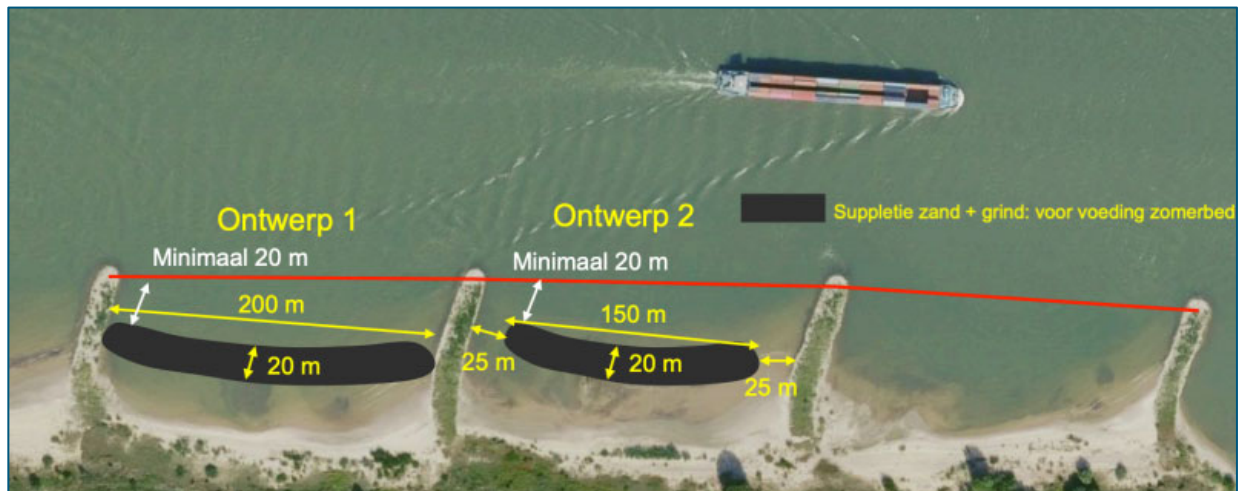
Figuur 3-3 Schets van de voorgestelde uitvoering van de suppletie van kribvakken volgens 2 ontwerpen (1) een ontwerp waarbij de suppletie aansluit op beide kribben (linker kribvak), en (2) een ontwerp waarbij tussen de suppletie en beide kribben een afstand van 25 m wordt aangehouden (rechter kribvak). De rode lijn verbindt de bakens op de koppen van de kribben.
